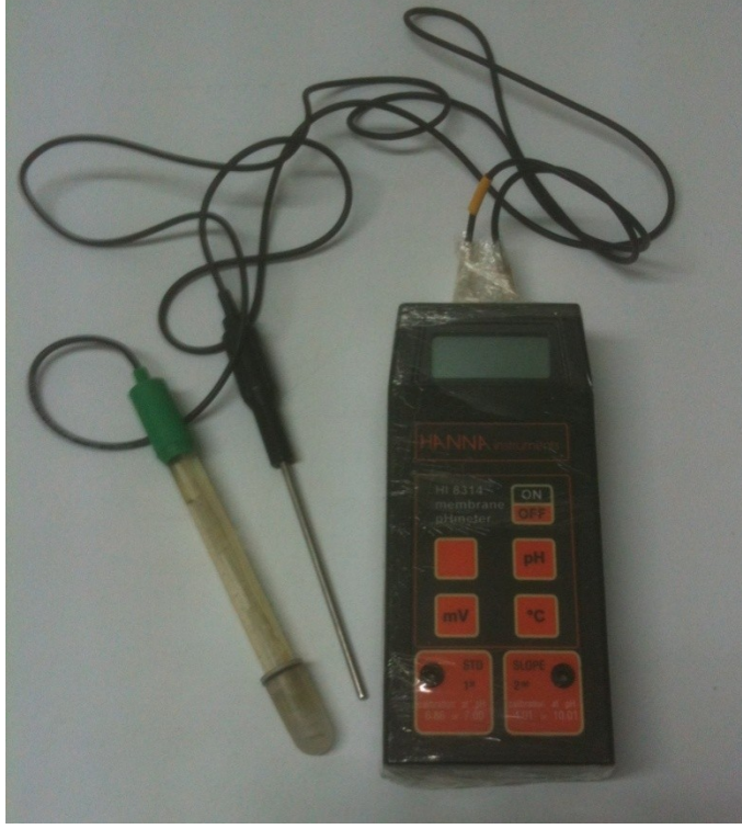
Şekil 4.3.1. HANNA HI 8314 model pH metre (Orijinal)
