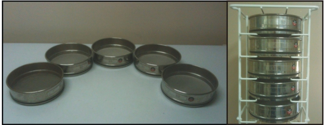
Şekil 4.2.1 Islak eleme yönteminde kullanılan elek sistemi (Orijinal)
