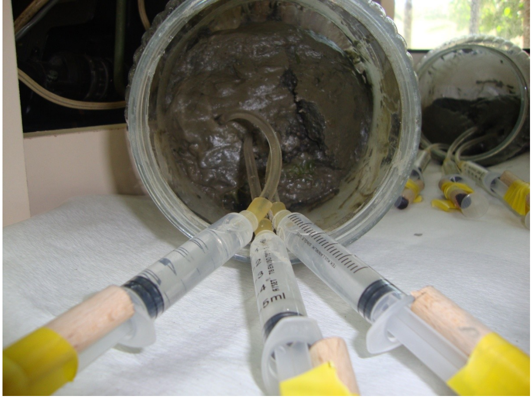
Şekil 4.1.2. Rhizon örnekleyici (Orijinal)
