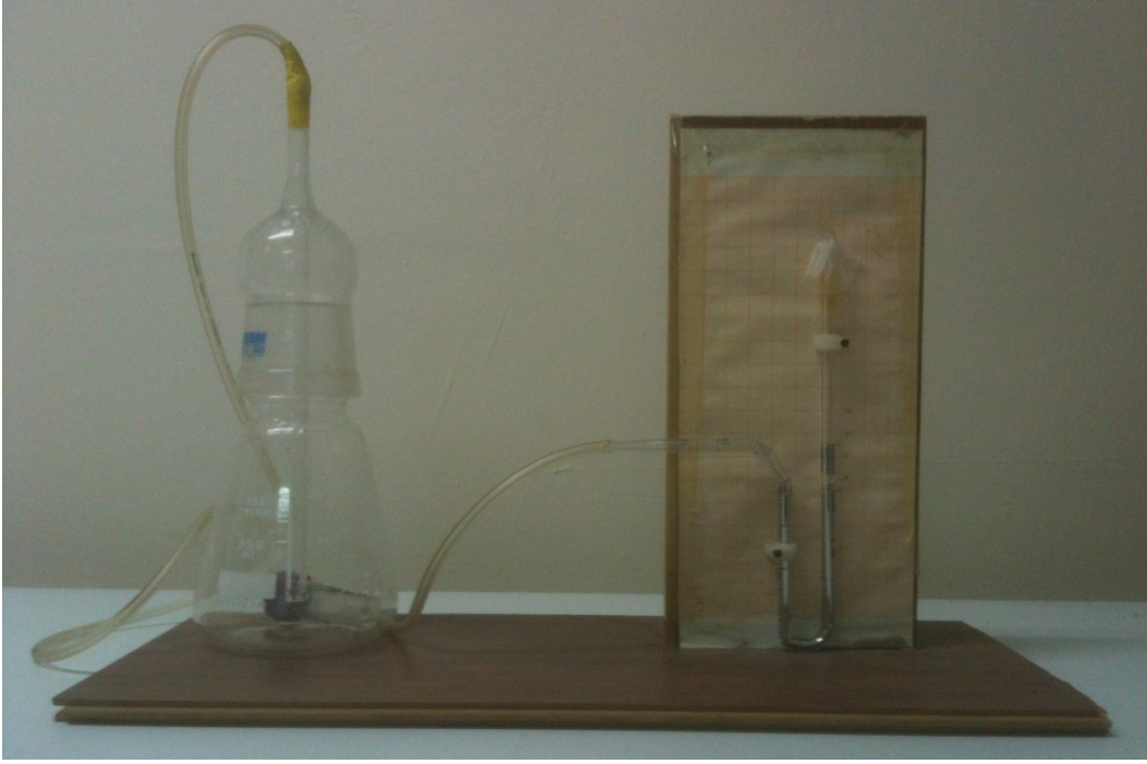
Şekil 4.2.2. Manometrik yöntemle sedimentte karbonat tayini sistemi (Orijinal)
