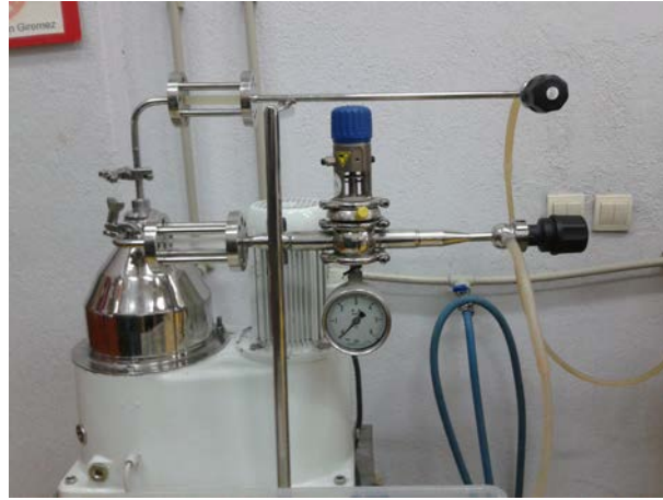
Şekil 3.7 30 litrelik biyoreaktör üretimi sonucunda biyokütleyi kültür ortamından ayırmak için kullanılan çanaklı santrifüj
