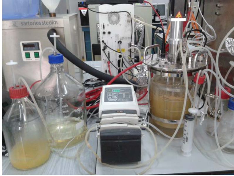
Şekil 3.5 Sürekli sistemde kullanılan 2 litrelik biyoreaktör
