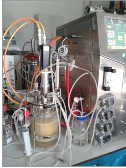
Şekil 3.4 C. saccharophila ve C. cohnii hücrelerinin yetiştirilmesinde kullanılan 2 litrelik biyoreaktör
