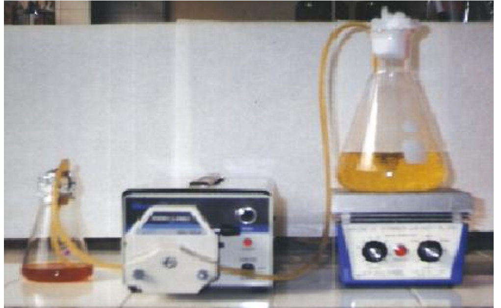
Şekil 3.2 Ca-aljinat boncuklarının elde edilmesi (solda: hücre süspansiyonu+ Na-aljinat çözeltisi karışımı, sağda: boncukların oluşmaya başladığı %2'lik \text{CaCl}_2 çözeltisi)
