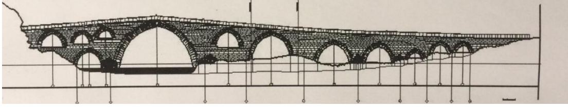
Çizim 3.30. Çeşnigir köprüsü mansap tarafından (VGM Arşivinden)
