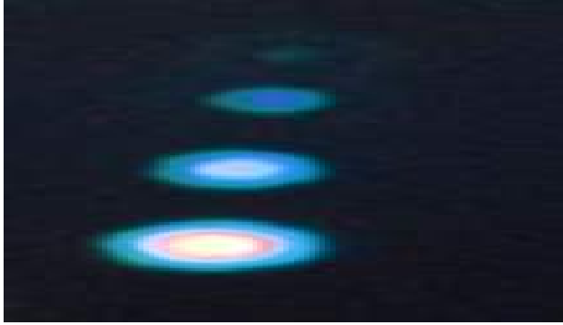
Şekil 4.10: 5 cm mesafe ve 11cm derinlikteki taklit lezyonların statik çekim görüntüsü
