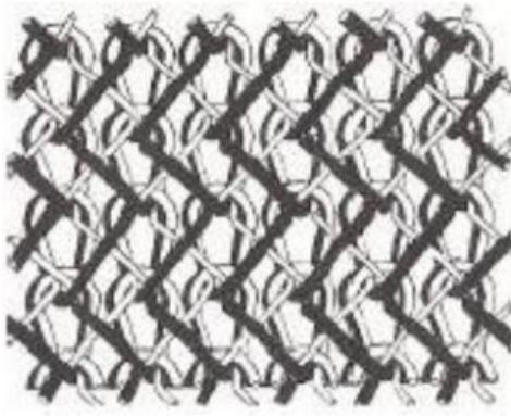
Resim 2.32. Tricot kumaş örme yapısı (Küçükali, 2010, s. 23).
