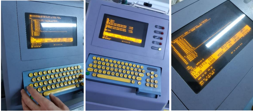
Resim 4.13. CMS 302 STOLL örme makinesine desen yüklenmesi ve yazılım ayarlarının gerçekleştirilmesi
