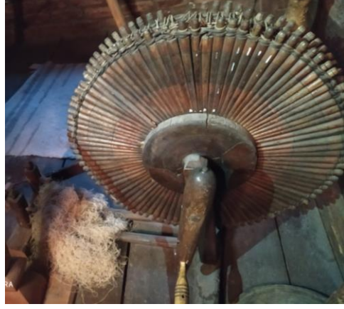
Resim 2.10. Çıkırıktaki Masuraya İp Sarılması (Gürbüzer,2015)
