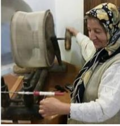
Resim 2.10. Çıkırıktaki Masuraya İp Sarılması (Gürbüzer,2015)
