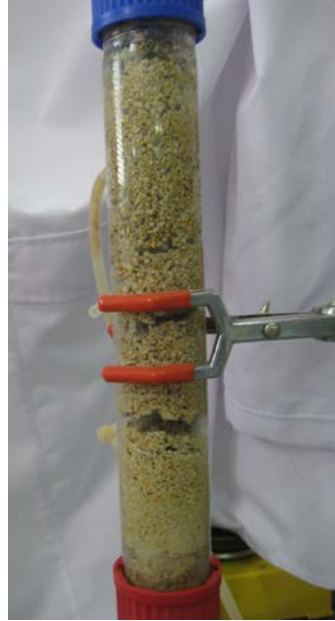
Şekil 4.61 Sürekli üretim sonunda pomza taşı dolgulı biyoreaktörün görünümü.
