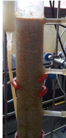
Şekil 4.101 Sürekli üretim sonunda cam boncuk dolgulu biyoreaktörün görünümü.
