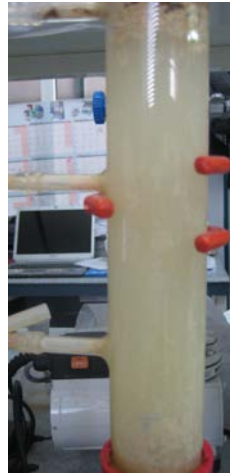
Şekil 4.25 Sürekli üretim sonunda dolgu malzemesiz biyoreaktörün görünümü.
