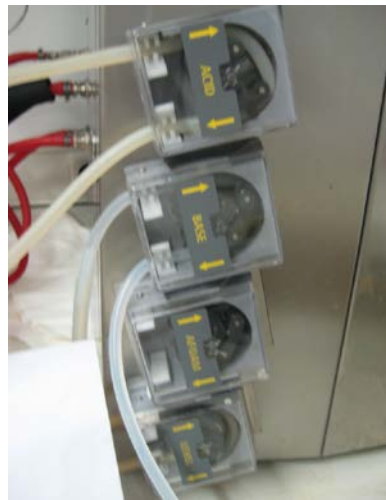
Şekil 3.3 Sürekli denemelerde kullanılan peristaltik pompalar.
