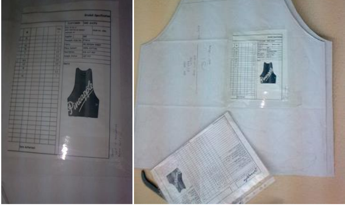
Şekil 6.16. Kesim esnasında kalıpların karışmasını önlemeye yönelik yapılan uygulamanın bir örneği.
