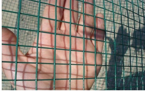
řekil 3.14Kafeslerin Üst Kısımında Kullanılan Plastik Kaplı Tel
