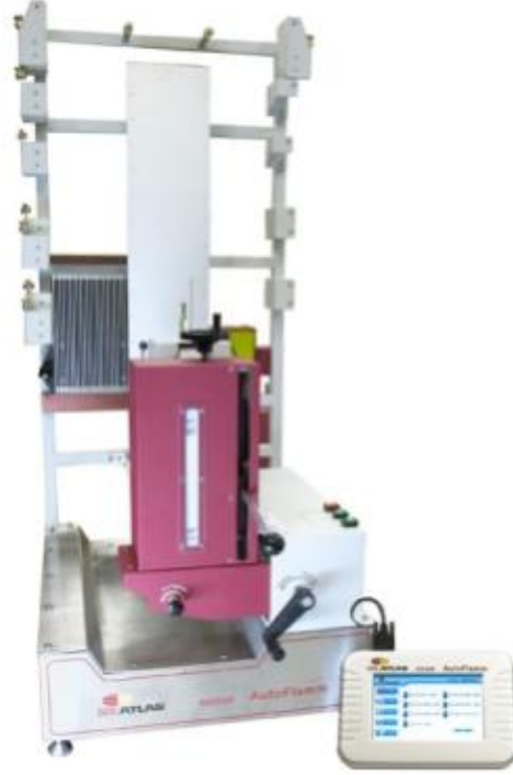
ekil 3.3. SDL ATLAS Firması'nın M233B model güç tutu ruluk test cihazı
