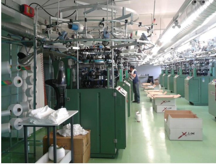
Şekil 4.1 Santoni örme makinesi üretim hattı
