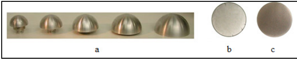
Şekil 2.8: a: Trim test mantarları b: Kırılmış kumaş görüntüsü c: Uygun kumaş görüntüsü
