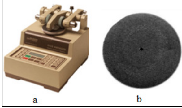
Şekil 4.8: a: Taber test cihazı b: Test uygulanmış numune
