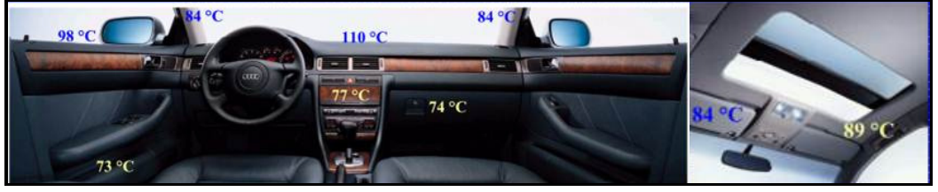
Şekil 3.1: 47°Clik dış ortam sıcaklığında araç içi parça sıcaklıkları (Schmidt, 2005)
