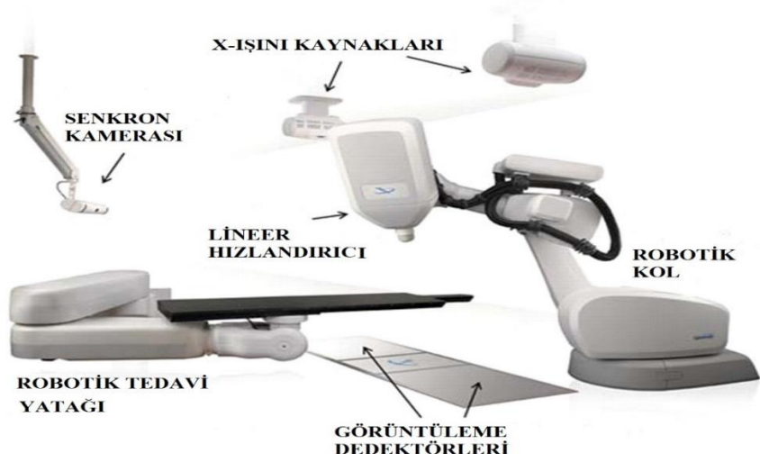
Şekil 3.1 CyberKnife Tedavi Cihazının Bölümleri
