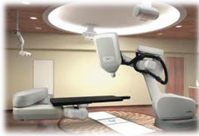
Şekil 2.3 CyberKnife Robotik Radyocerrahi Sistemi
