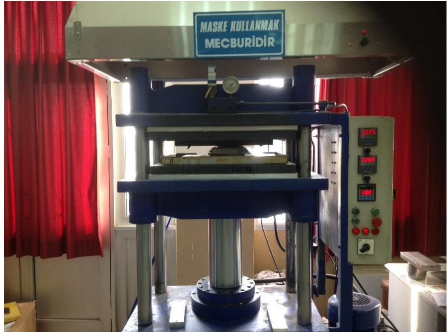
Şekil 4.6 Isıtmalı preste kompozit malzemenin üretilmesi
