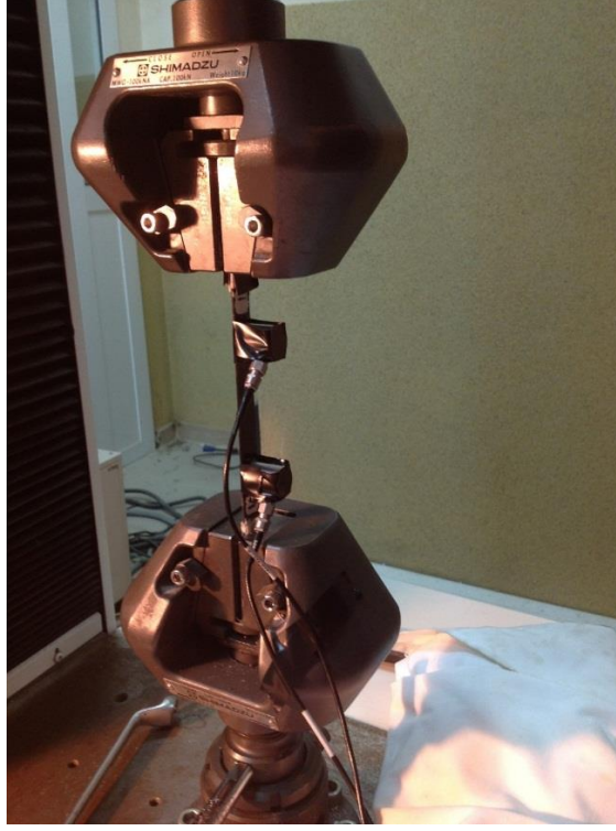
Şekil 4.8 SHIMADZU (Japonya) Universal test cihazında çekme testleri.
