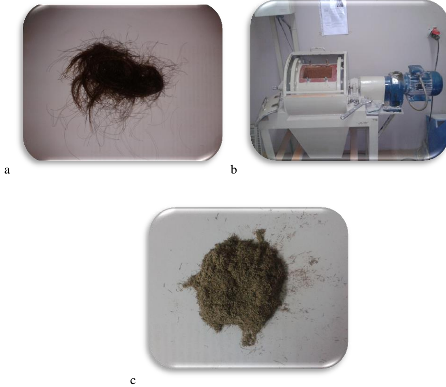
Şekil.10 a) Bilyalı değirmene girmeden önceki saç örneklerinin görünümü b) Kullanılan bilyalı değirmen c) Öğütme sonrası toz haline gelen saçların görünümü
