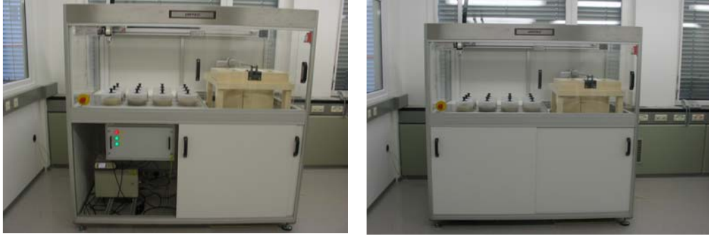
Şekil 3.10: Gama spektroskopik ölçüm sistemi, Seibersdorf Laboratuvarları ( Mabbit, 2006 ).
