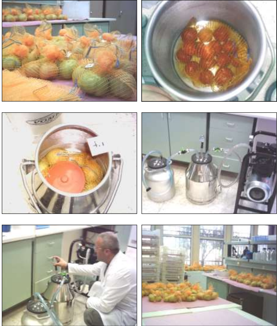
Şekil 3.7. Vakum infiltrasyon yöntemiyle AVG uygulaması.
