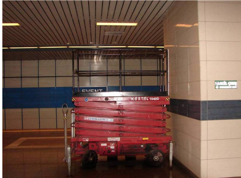
Şekil 7-9 : Yüksek Yerlerdeki Armatürlere Erişim İçin Özel İmal Ettirilmiş Katlanabilir Merdiven
