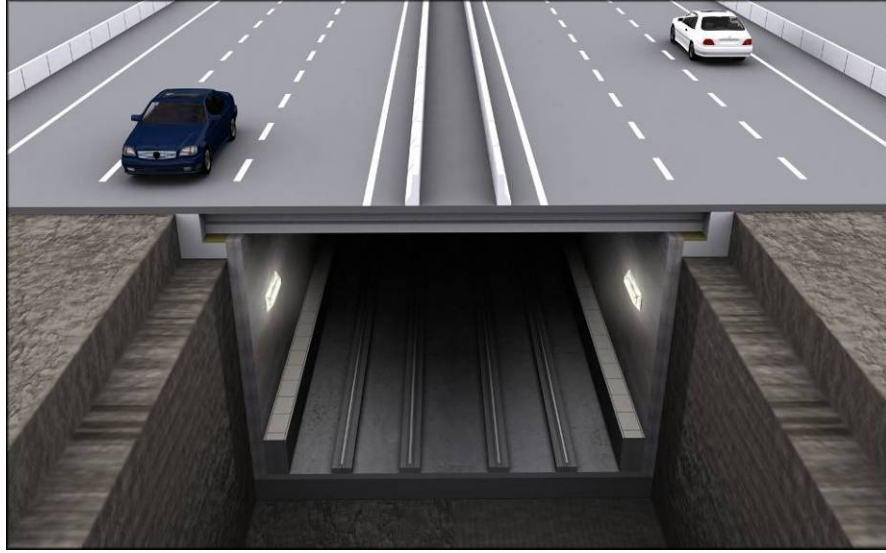
Şekil 6-2 : Yeraltı Metro Sistemine Ait Örnek Bir Hat Kesiti
