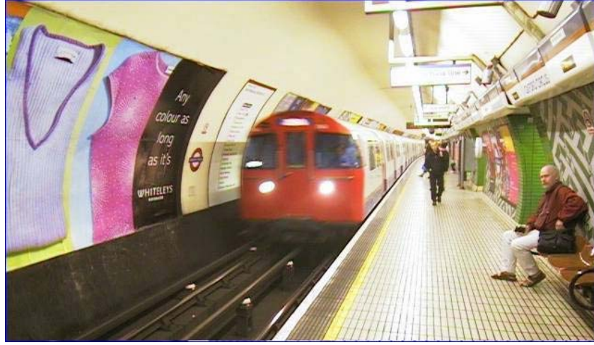
Şekil 6-4 : Yan Platform Tipine Bir örnek
