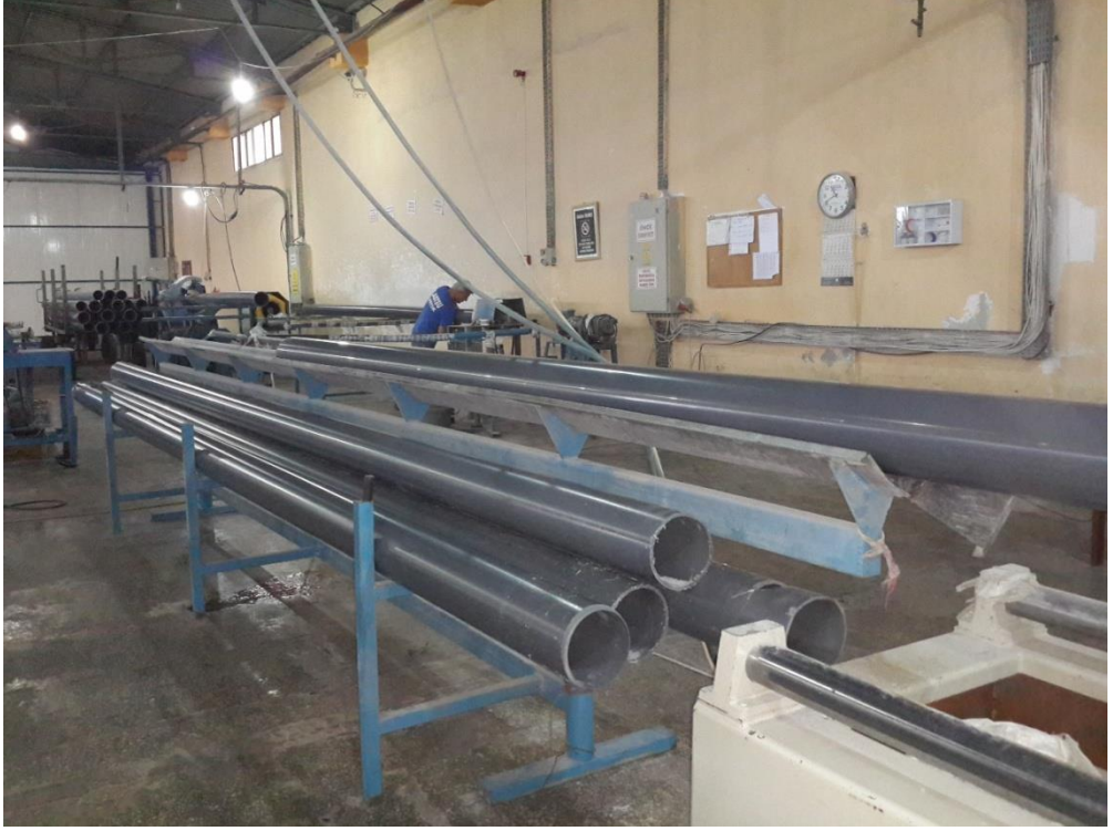
Şekil 7.8 Boyutlandırılan boruların kontrol edilerek istifleme raflarına alınması
