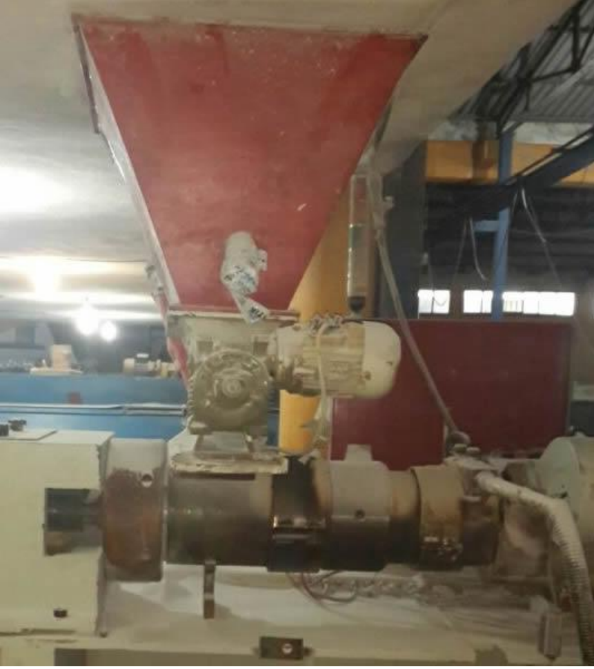
Şekil 7.3 Besleme hunisi ve extruder
