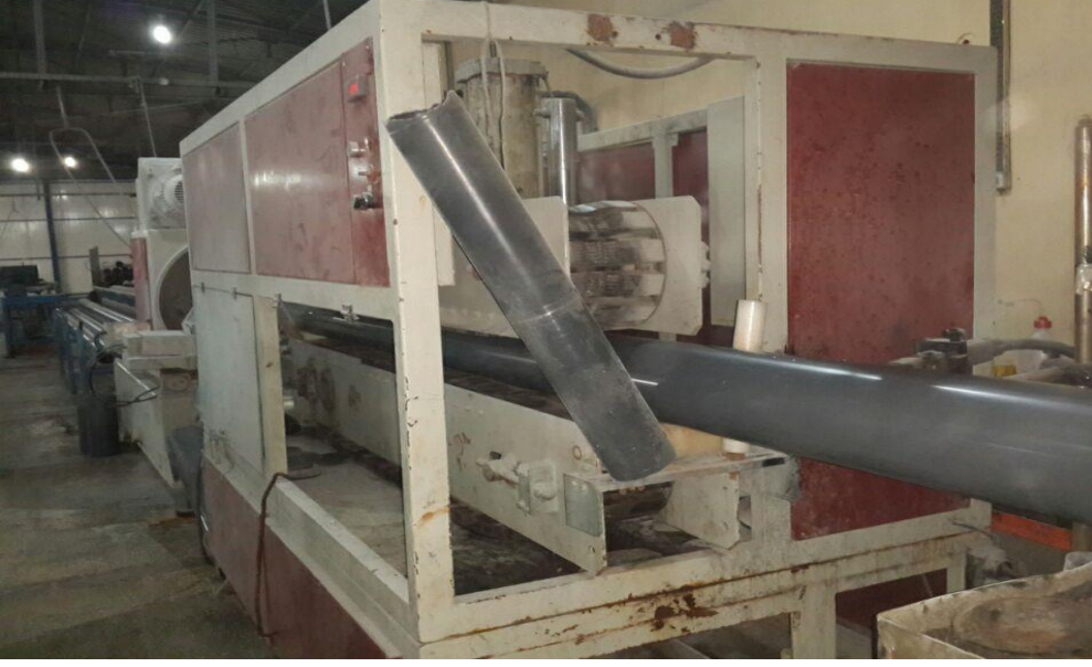
Şekil 7.6 Borunun dış yüzeyinin şekillendirilmesi
