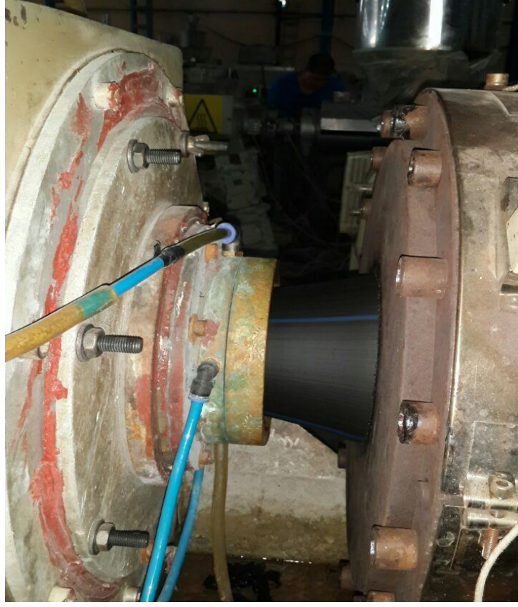
Şekil 7.4 Hamur haline getirilen hammaddenin, sonsuz vidanın oluşturduğu basınçla itilerek, kalıptan dışarı alınması.
