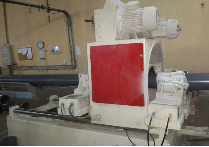
Şekil 7.7 Borunun kesicilerle belli uzunluklarda kesilmesi
