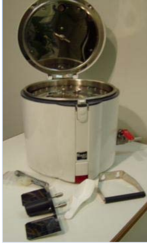
Şekil 4.6 Kimyasal iz kazıma banyo ünitesi (Radosys, 2000).
