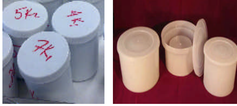
Şekil 4.3 : Silindirik kap ve Marinelli kabı.
