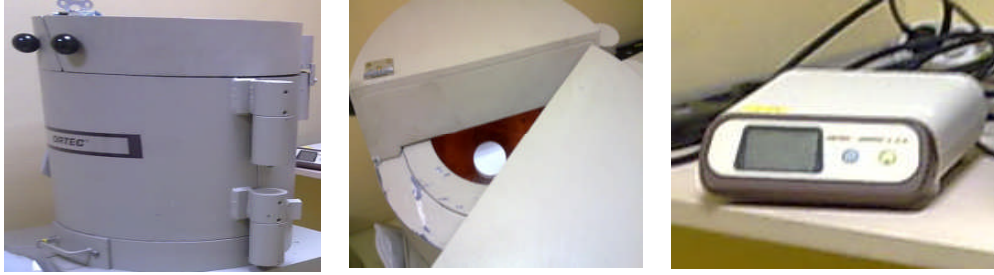
Şekil 3.5 : Detektör zırhı, detektör ve dijital spektrometre.
