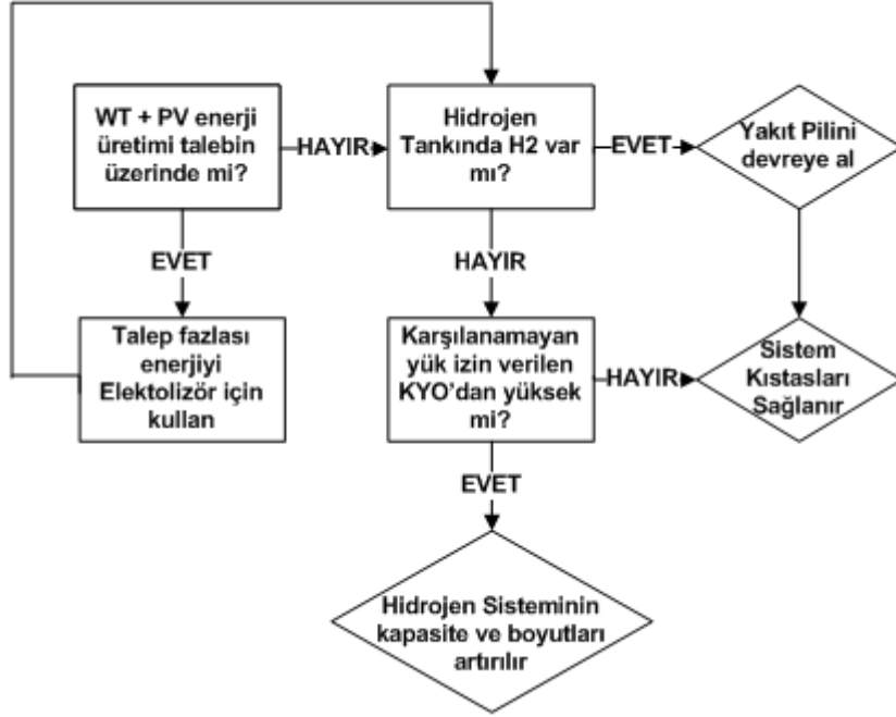
Şekil 5.2 : Şebekeden bağımsız sistem akış diyagramı.
