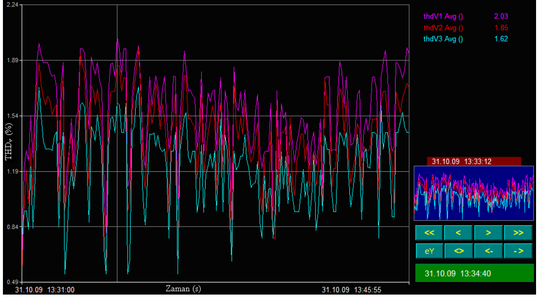
Şekil 6.11 : A Medya tesisinde THD v grafiği
