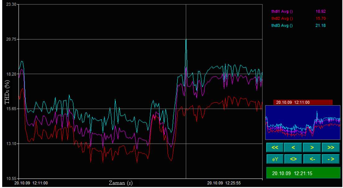
Şekil 6.18 : B Matbaa tesisinde THD 1 grafiği
