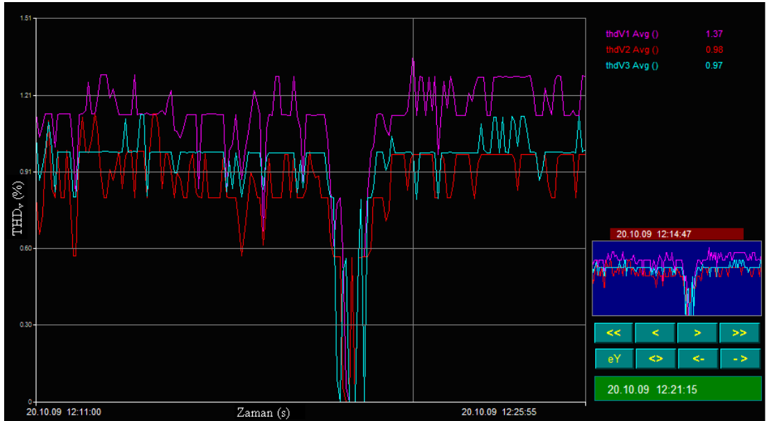
Şekil 6.19 : B Matbaa tesisinde THD v grafiği
