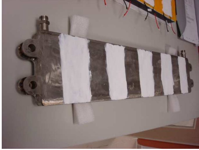
Şekil 3.25 : Isı deęiřtiricisinin ısı pastalanıřı.
