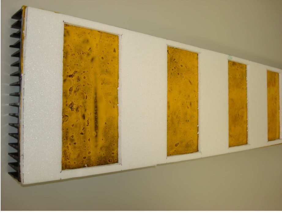
Şekil 3.12 : İzolasyonlu kanatçıklı yüzey.
