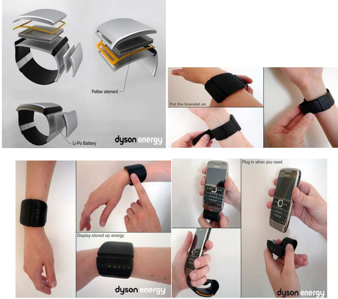
Şekil 2.13 : Vücut ısıyla Li-Po pil şarj eden bir termoelektrik uygulaması.
