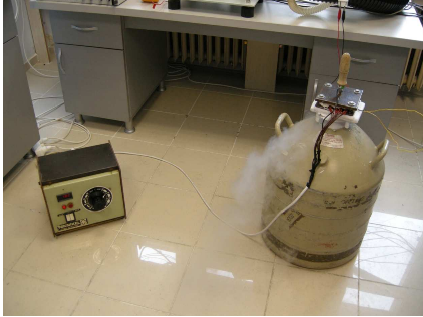
Şekil 4.1 : Variak trafo ve devar kabı.
