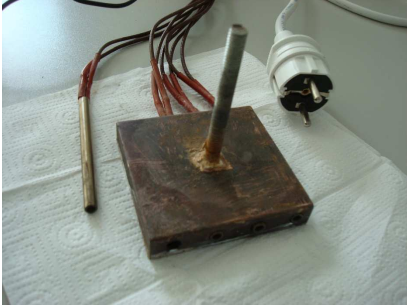
Şekil 4.2 : Bakır ısıtıcı ve paslanmaz fişekler.
