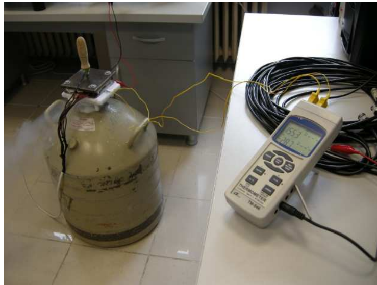
Şekil 4.5 : Lutron marka termometre.
