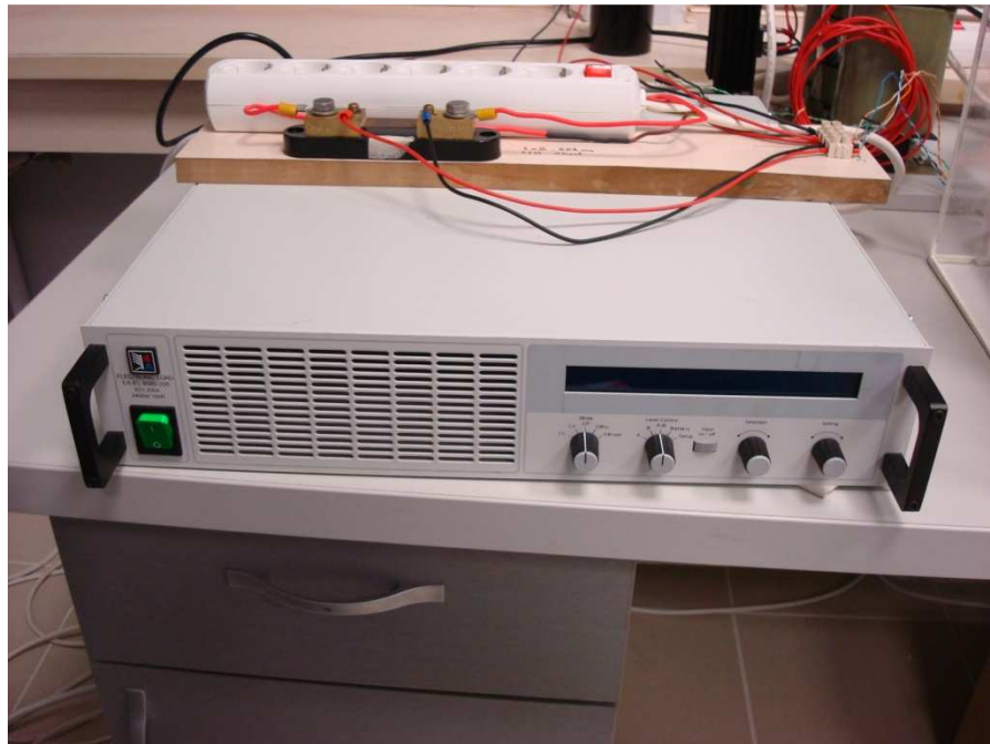
Şekil 3.28 : Elektro-Atomatik firmasının 9080-200 elektronik yükü.
