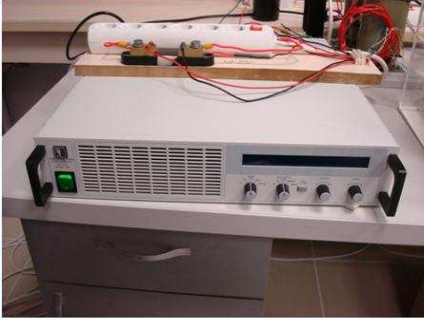
Şekil 5.13 : Elektro-Aomatik EL 9080-200 elektronik DC yük.
