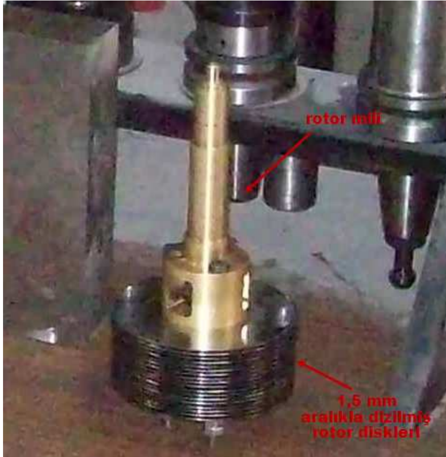
Şekil 2.11 : TT’nin rotoru ve birbirine 1.5 mm aralıkla dizilmiş rotor diskleri.
