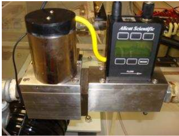
Şekil 5.8 : Debi kontrolörünün önden görünüşü.
