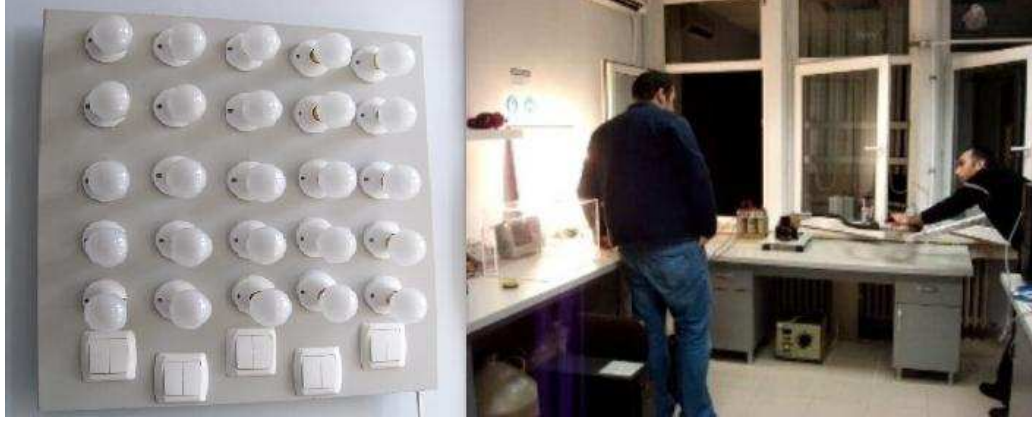
Şekil 5.14 : Üretilen gücü göstermek amacı ile lambalarla yapılan pano.
