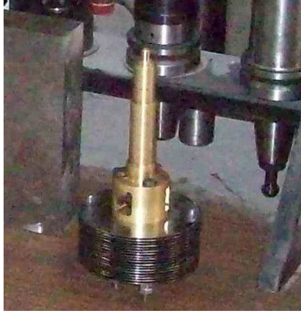
Şekil 4.6 : Disk grubu ve milin birlikte çekilmiş fotoğrafı.
