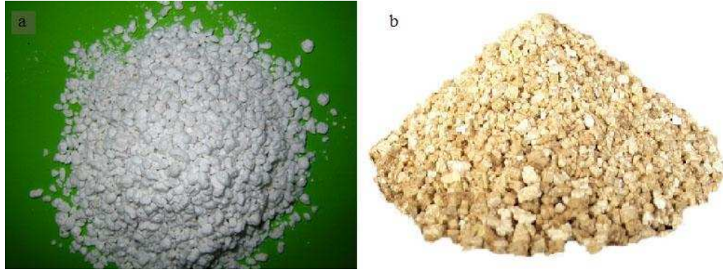
Şekil 2.7 : Kullanımı yaygın olan toz yalıtım malzemeleri a) Perlit b) Vermikülit.
