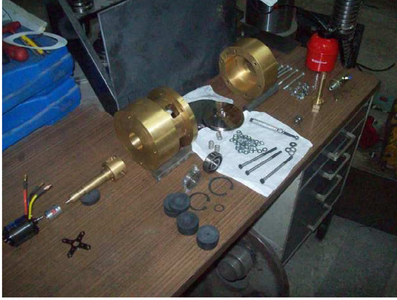
Şekil 4.8 : Türbini oluşturan parçaların genel görünüşü.
