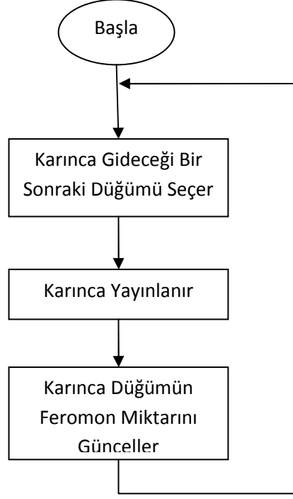
Şekil 6.4: ANCOR algoritması yönlendirme safhası akış diagramı
