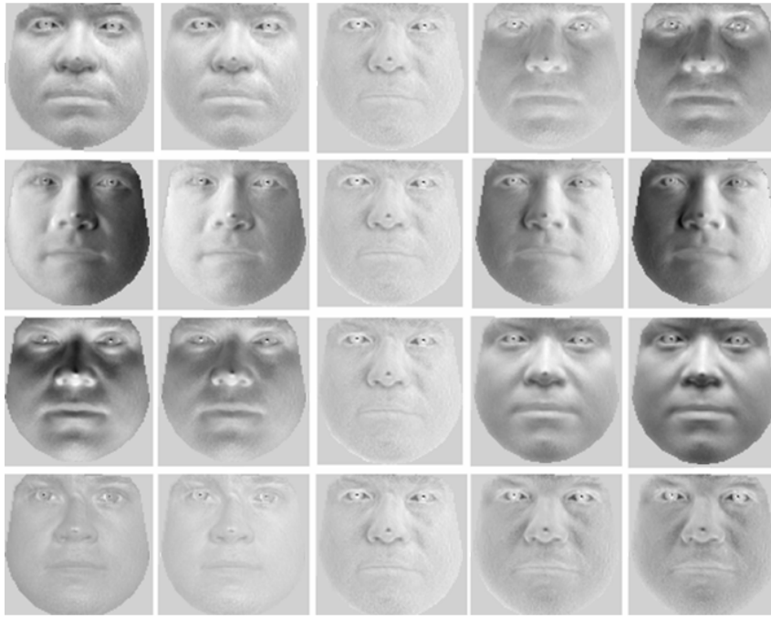
Şekil 8.7. Aydınlatma yüz modeline ait mod değişimleri. Her satır aydınlatma modeline ait bir temel bileşeni göstermektedir. Her sütun ise soldan-sağa -2, -1, 0, 1, 2 mod değişimlerini göstermektedir.
