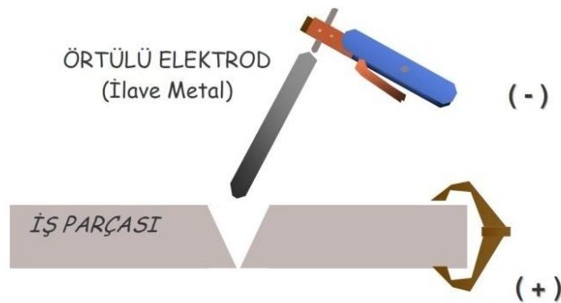
Şekil 1.4 Örtülü elektrod ile yapılan kaynak yöntemi (Komaç, 2009).
