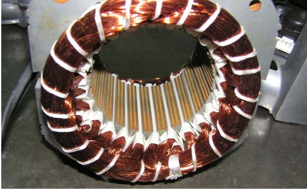
Şekil 6.12 : Üretilen Karma Model -5 prototipine ait stator laminasyonu ve çift tabakalı sargı.
