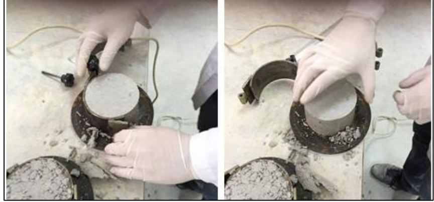
Şekil 3.7. Klor-iyon geçirgenliği deneyi örnekleri
