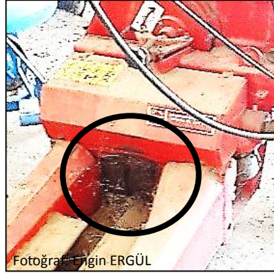
Şekil 1.21 Silajlık mısır hasat makinası biçme düzeni.
