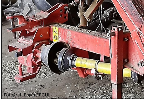
Şekil 1.25 Silajlık mısır hasat makinası mafsallı mil ve dişli kutusu.
