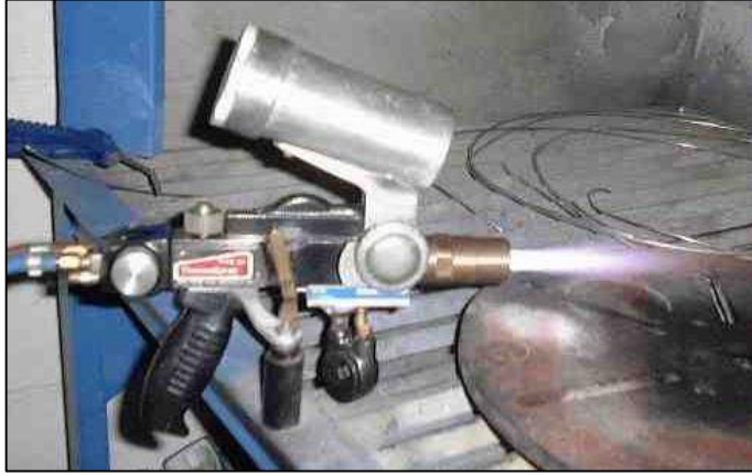
Şekil 1.38 Alevle toz püskürtme yönteminin uygulama alanları (Gordon England, 2013)
