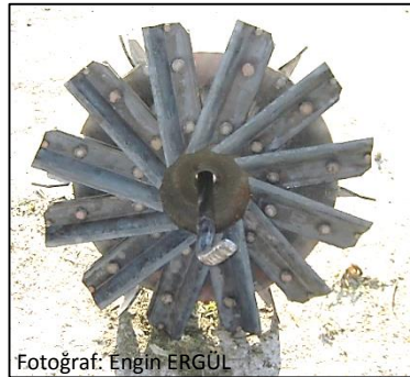
Şekil 4.8 Silajlık mısır hasat makinası içindeki disk üzerine takılmış kıyıcı bıçaklar.
