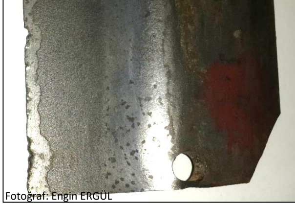
Şekil 6.2 B kodlu bıçak üzerinde kaplamanın attığı kesme kenarı.
