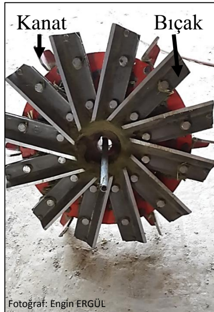
Şekil 1.23 Silajlık mısır hasat makinası diskli kıyma ünitesi.
