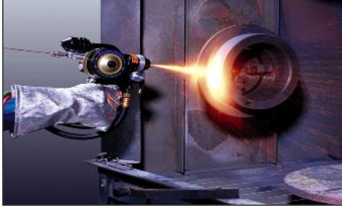
Şekil 1.34 Alevle tel püskürtme yönteminin uygulanması (Prokap, 2014)
