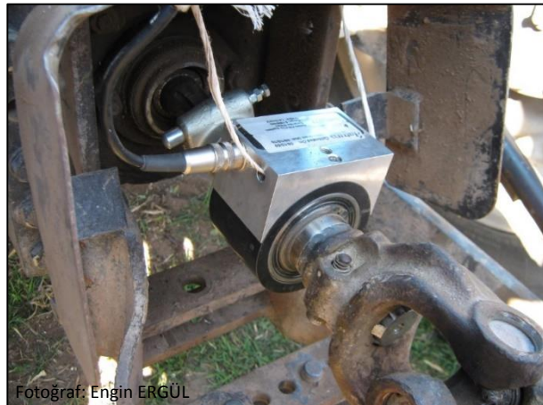
Şekil 4.11 Traktör kuyruk mili ile kardan mili arasında bağlı torkmetre.
