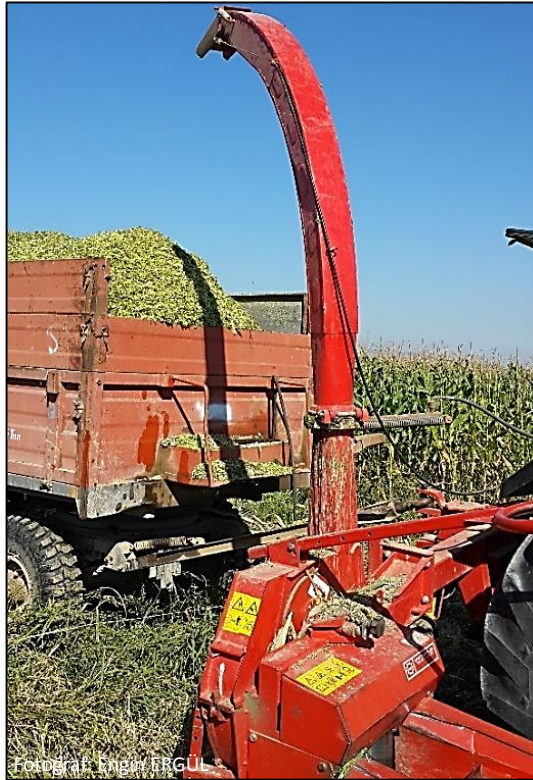
Şekil 4.7 Hidrolik kumandalı silajlık mısır hasat makinası.
