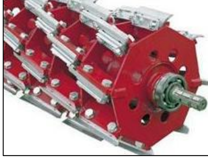
Şekil 1.22 Parçalı bıçaklı tamburun kıyma ünitesi (Kasap vd., 2000).
