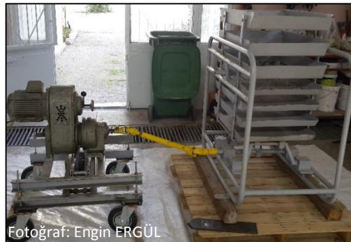
Şekil 4.19 Elek sistemi ve hareket motoru.
