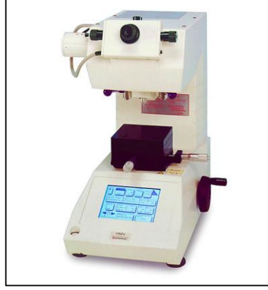
Şekil 4.16 Mikro sertlik ölçümünde kullanılan Vickers ünlversal sertlik ölçüm cihazı.
