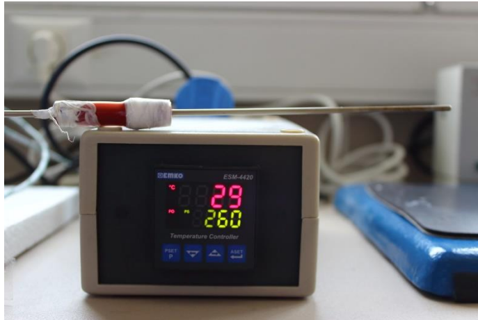
Şekil 3.2. İşlem sıcaklığının ayarlanmasında ve sıcaklığın sabit tutulmasında kullanılan elektronik kontrollü termokupl
