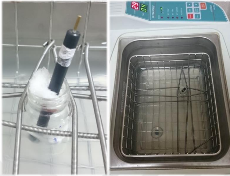
Şekil 3. 12. Ultrasonik banyoda yapılan temizlik işlemi
