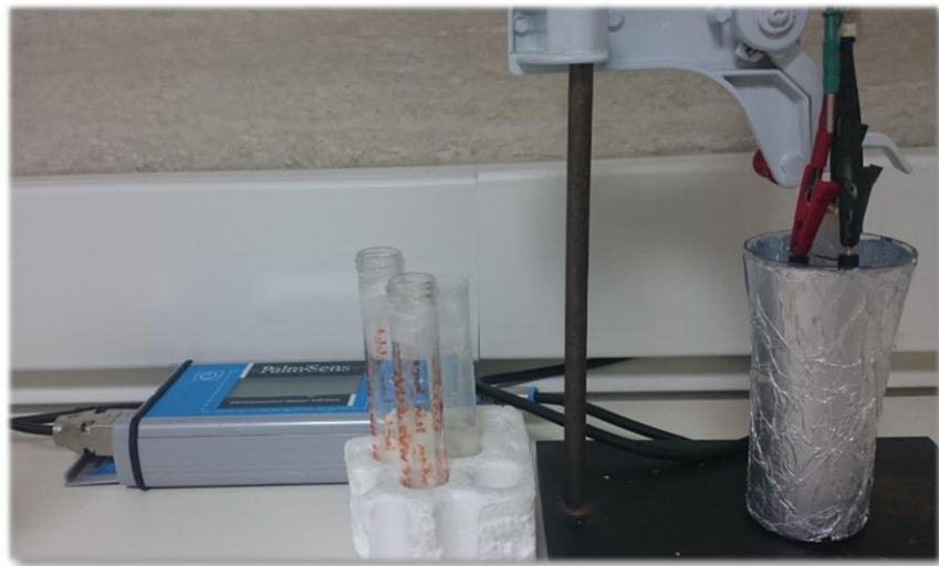
Şekil 3. 32. Depo kararlılığı denemesinin ölçüm düzenegi
