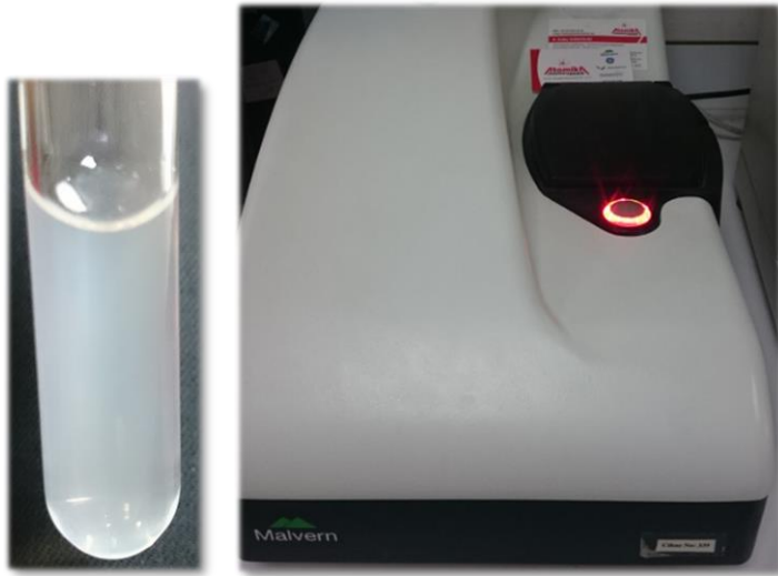
Şekil 3. 5. Zeta-Size analizi için hazırlanan örneğin görüntüsü ve Zeta-Size Cihazı
