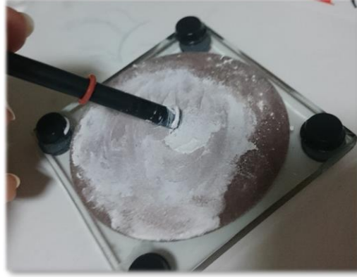
Şekil 3. 10. Keçe üzerinde alümina ile yapılan temizlik işlemi
