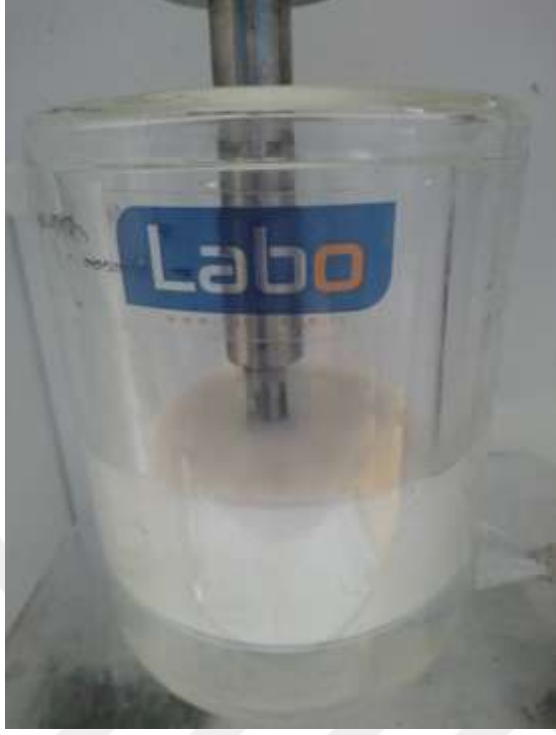
Şekil 3.2. Reçinenin ultrasonik karıştırıcı ile karıştırılması.
