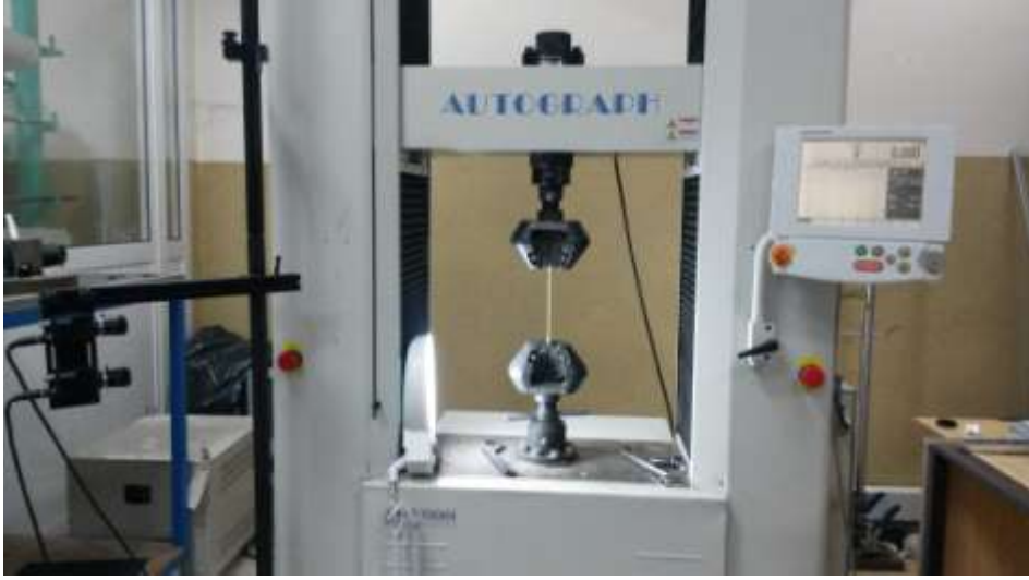
Şekil 3.8. Shimadzu marka test cihazı ve çekme testinin yapılışı.
