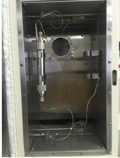
Şekil 3.15: Ekstraksiyon kolonunun sisteme monte edilmiş görünümü
