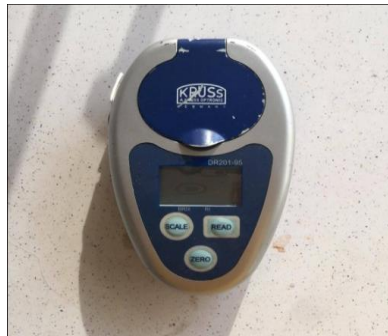
Şekil 3.7: Analizlerde Kullanılan Refraktometre (Krüss (Almanya))
