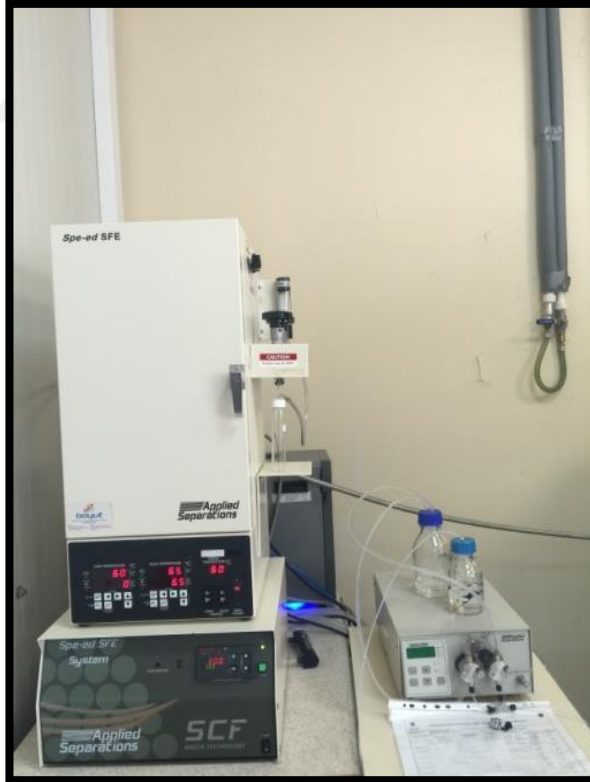
Şekil 3.11: Süperkritik Karbondioksit Ekstraksiyon Cihazı (Spe-ed SFE 2 model Applied Separations (ABD))
