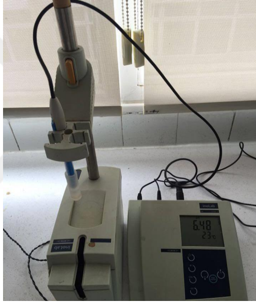
Şekil 3.8: Analizlerde Kullanılan pH metre (Inolab pH level 1 (Germany))
