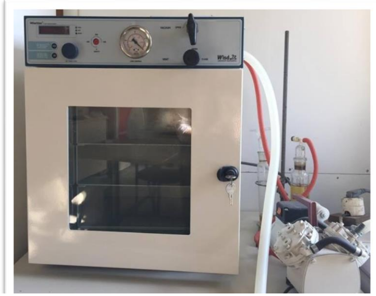
Şekil 3.6: Analizlerde Kullanılan Vakumlu Etüv (WiseVen WOW-30 (Almanya))
