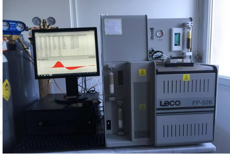
Şekil 3.9: Analizlerde Kullanılan Protein Tayini Cihazı (Leco FP-528 Nitrogen Analyser (Michigan, USA))
