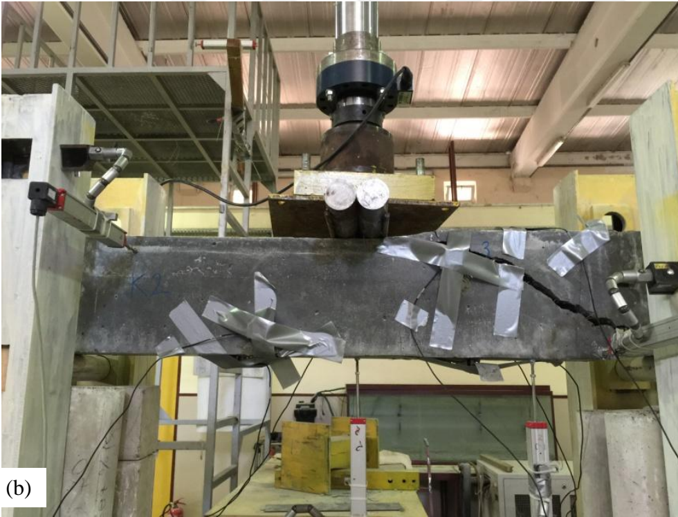
Şekil 5.10 Eğilme deneyinden (a) önce, (b) sonra K2 elemanı
