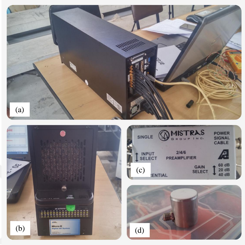
Şekil 4.11. AE düzeneği elemanları: (a) bilgisayarlı veri toplama sistemi, (b) ana toplayıcı, (c) önyükselteç, (d) sensör
