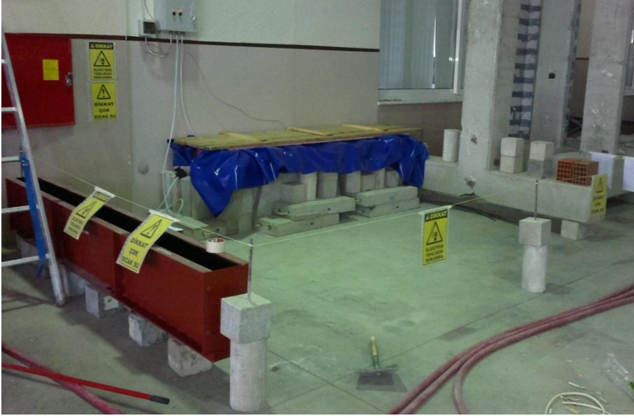
Şekil 4.7. Kiriş numuneler (125x250x1500mm) için 90 °C sıcak su kürü havuzu
