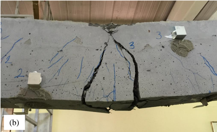
Şekil 5.15. Kırılmadan sonra yüklemeye devam edildiğinde (a) K3 elemanı ve (b) kırılma detayı
