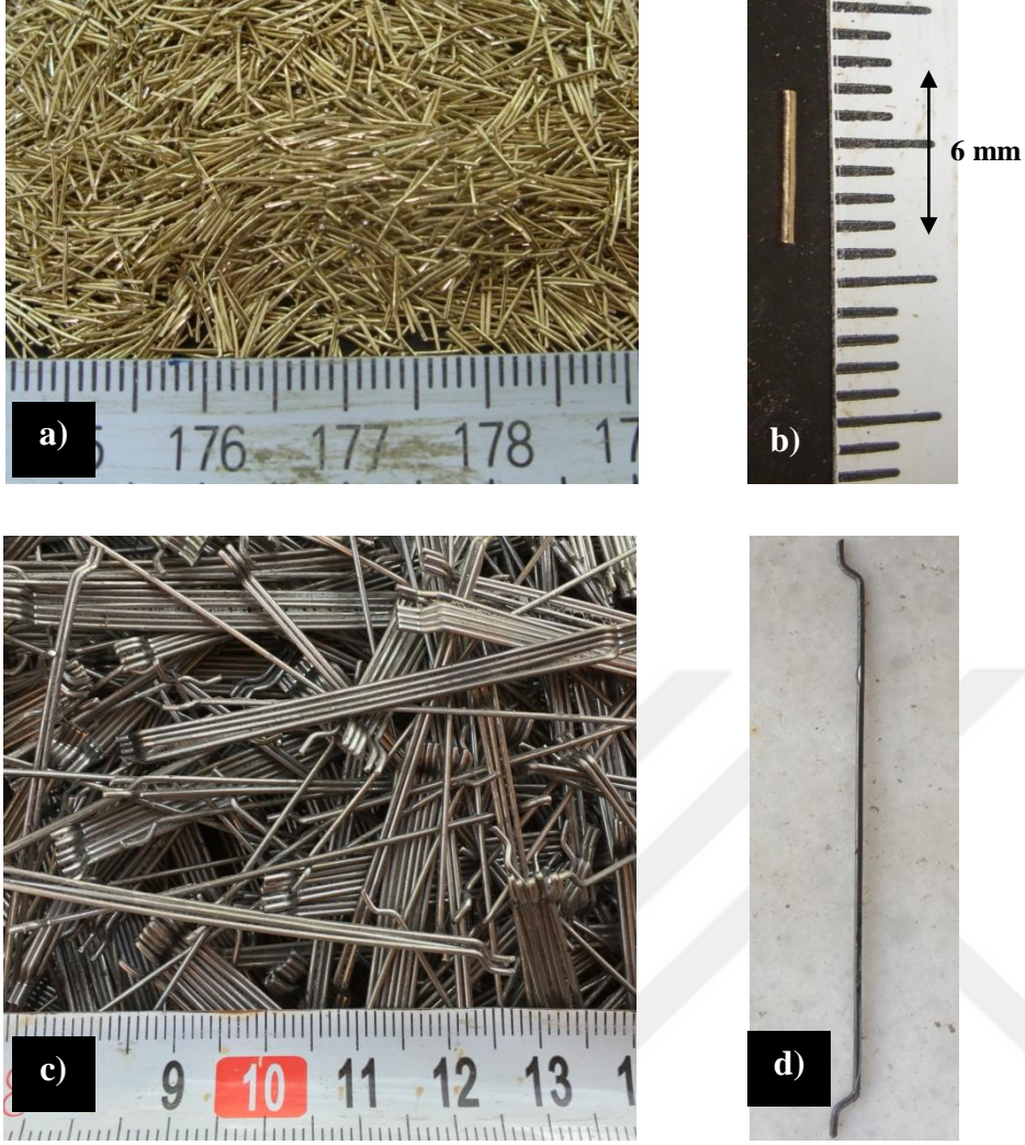
Şekil 4.2. Çelik lifler: (a)SF-1 çelik lif yığı, (b) tanesi, (c) SF-2 çelik lif yığı, (d) tanesi
