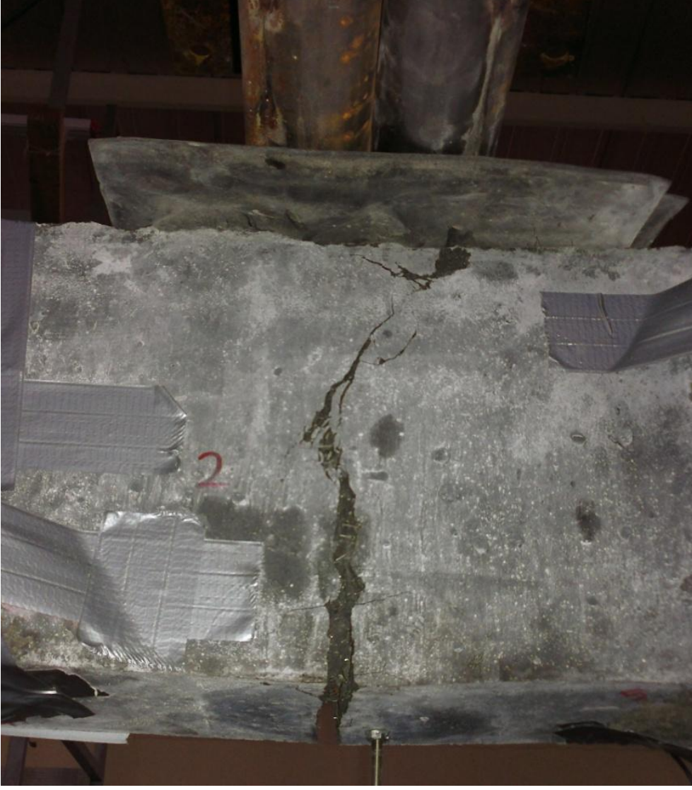
Şekil 5.8. K1 elemanı kırılma detayı
