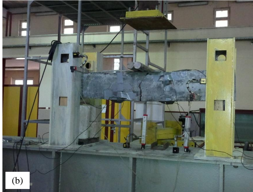
Şekil 5.7. Eğilme deneyinden (a) önce, (b) sonra K1 elemanı
