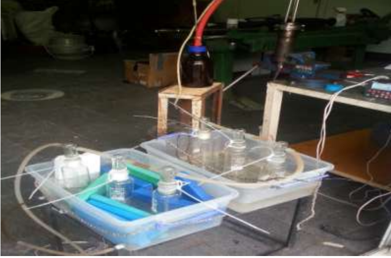
Şekil 3.5 Fermente atık ile sentez gazı arıtımı prosesi
