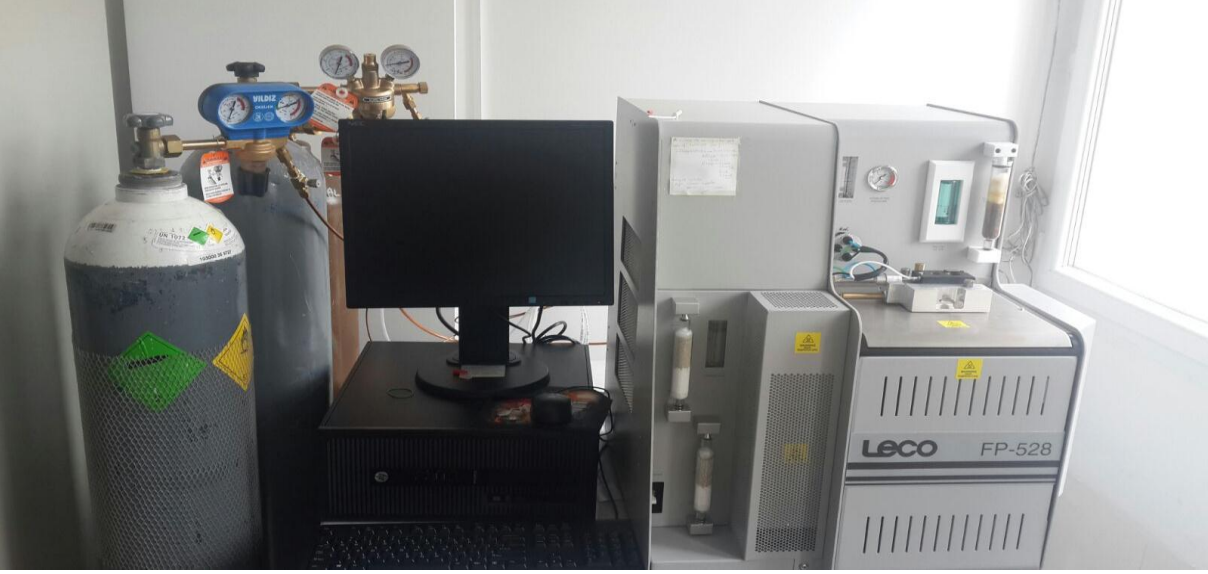
Şekil 3.1. Protein analizinde kullanılan LECO FP-528 Dumas cihazı
