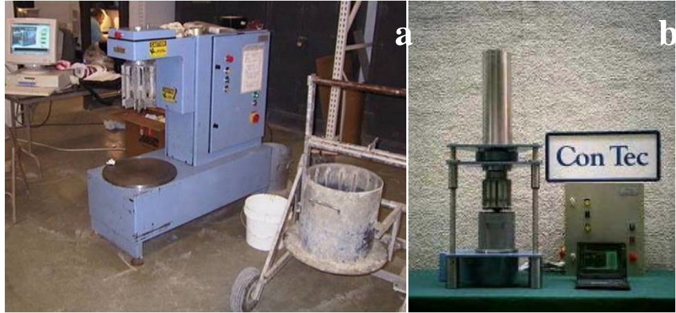
Şekil 1.17. BML reometresi, a: beton karışımları için uygun, b: harç ve çok akışkan beton karışımları için uygun
