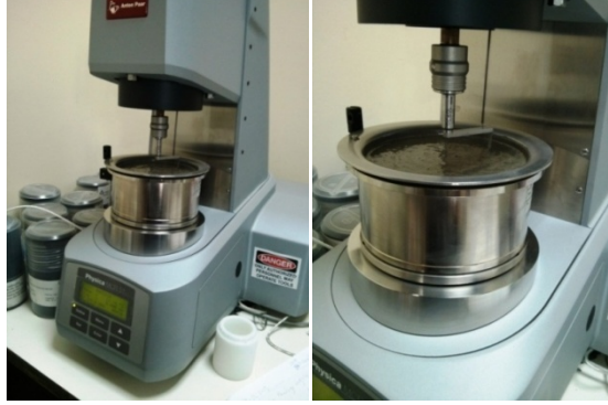
Şekil 3.3. Çalışmada kullanılan reometre
