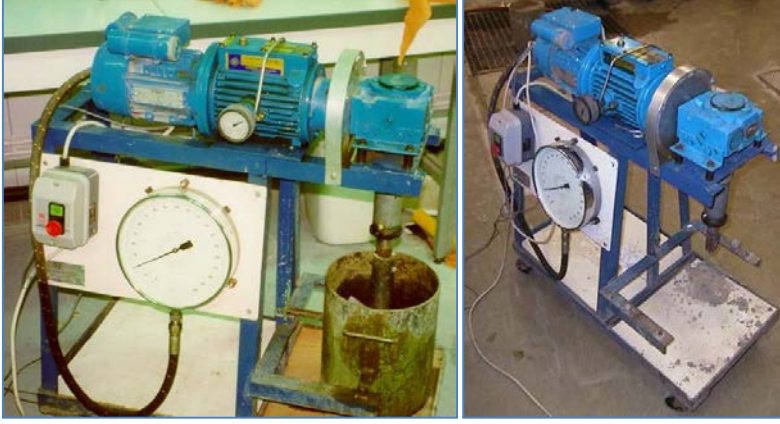
Şekil 1.15. İki-noktalı reometrenin genel görünümü
