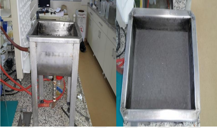
Şekil 4.2. Karışımın suyunu uzaklaştırmak için kullanılan vakumlu hazne
