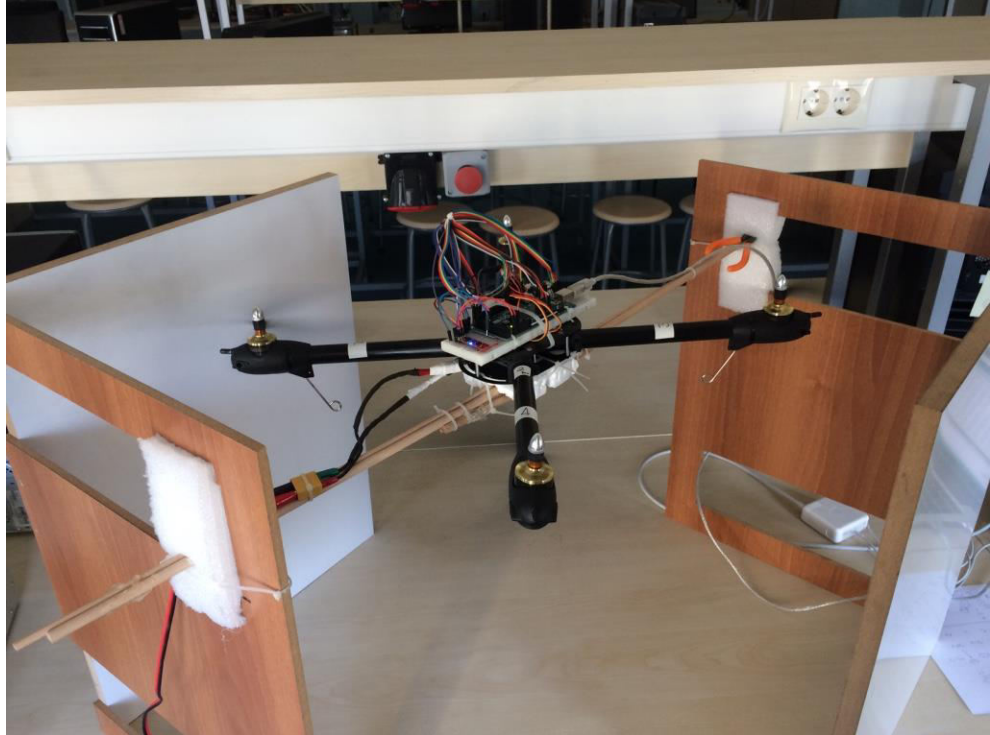
Şekil 6.3 Quadrotorun yatay düzlemde test düzeneği üzerindeki çalışması
