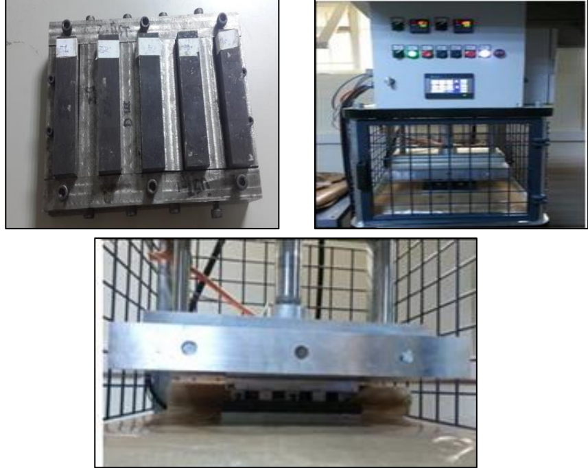
Şekil 4.26. Isıtmalı pres yardımıyla kompozit üretimi
