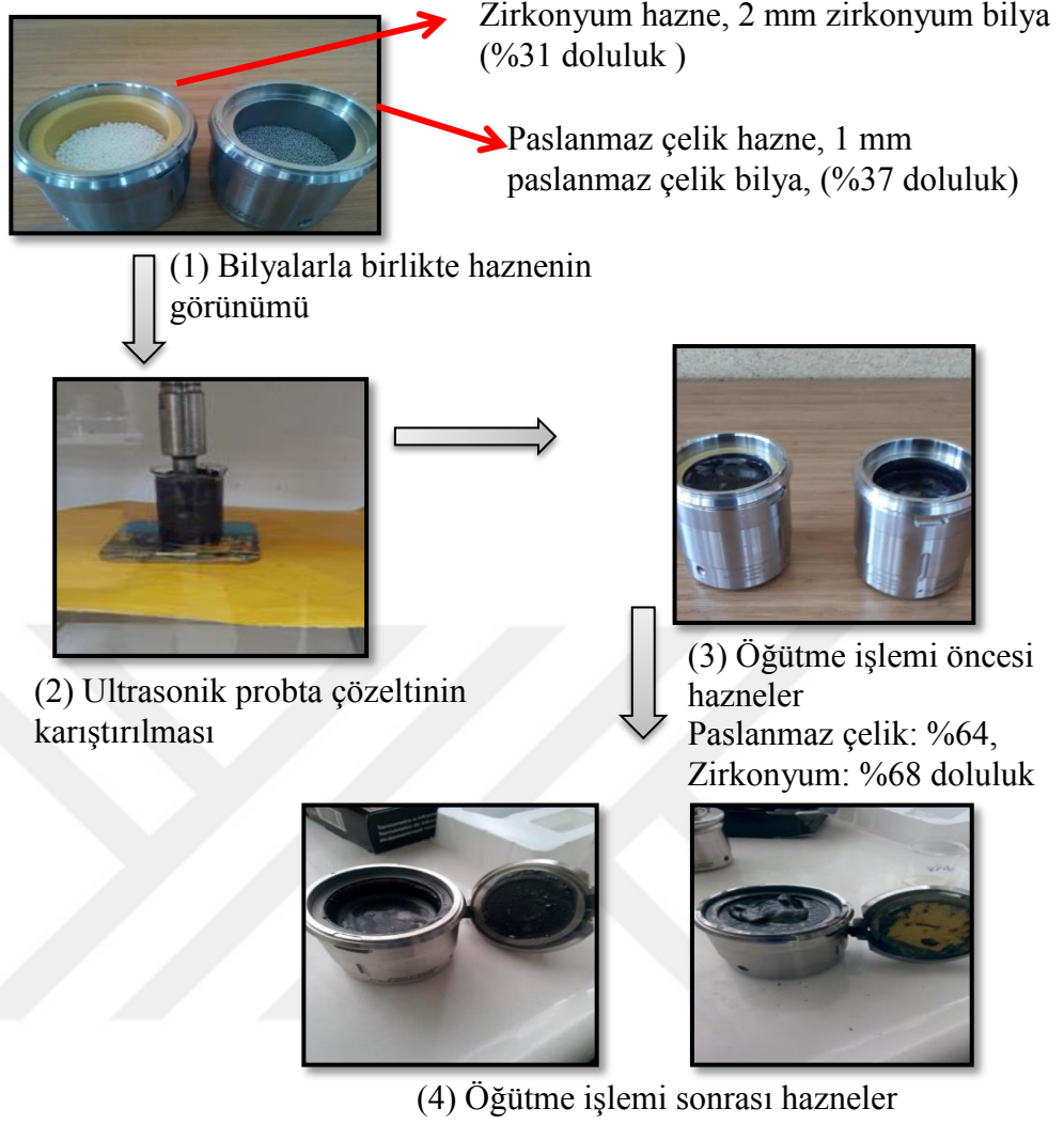
Şekil 4.9. Öğütme işlemi adımları
