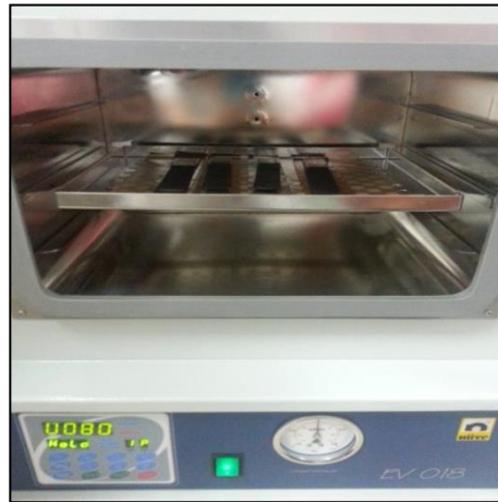
Şekil 4.24. Jelleşme için etüve koyulan film kompozitler
