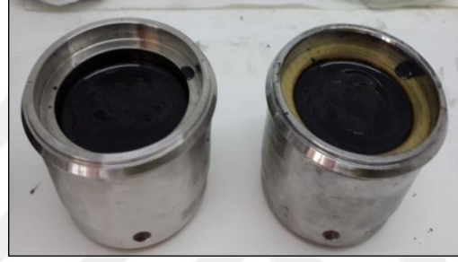
Şekil 4.17. Dönme hızı parametre incelemesinde öğütme işleminden önce haznelerin görünümü
