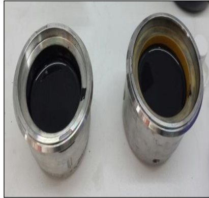
Şekil 4.15. BTO parametre incelemesinde öğütme işleminden önce çözeltilerin görünümü
