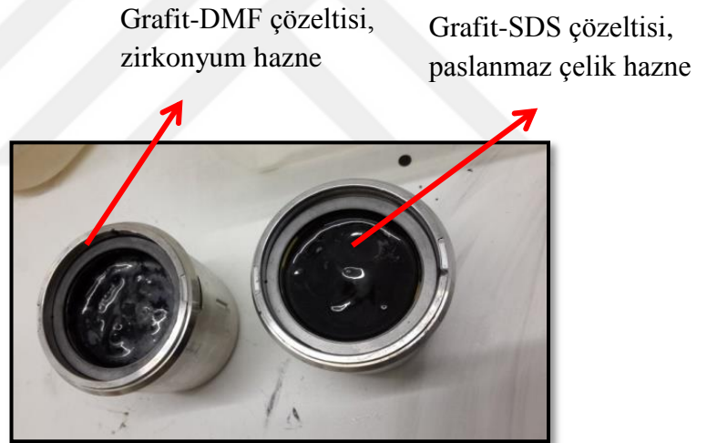
řekil 4.13. Ultrasonik karıřtırıcıda karıřtırma iřleminden sonra haznelerdeki özeltilerin görünlümü
