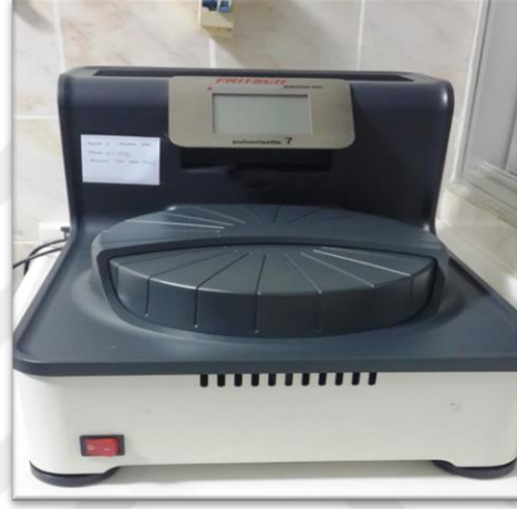
Őekil 4.8. Fritsch Pulverisette 7 đtme Cihazı
