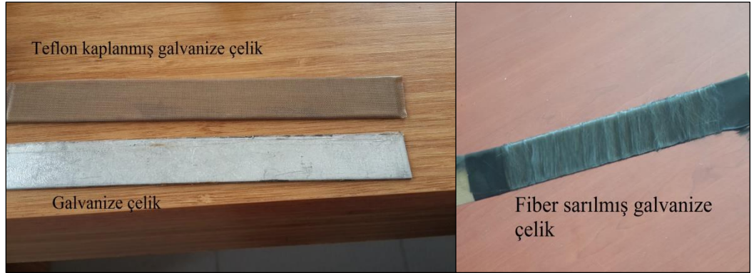
Şekil 4.20. Teflon kaplanmış ve iplik sarılmış galvanize çelikler
