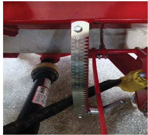
Şekil 2.2 Hidrolik piston ile kumanda edilen ayar kolu
