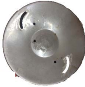
Şekil 2.5 Dağıtıcı disk üzerindeki oblong kanal
