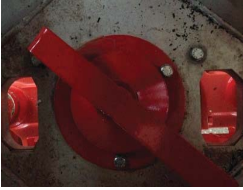
Şekil 2.3 Gübre deposu içinde bulunan karıştırıcı
