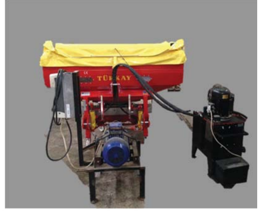
Şekil 3.5 Gübre akış denemeleri sırasında gübre dağıtma makinasının elektrik motoru ve hidro-motor bağlantıları
