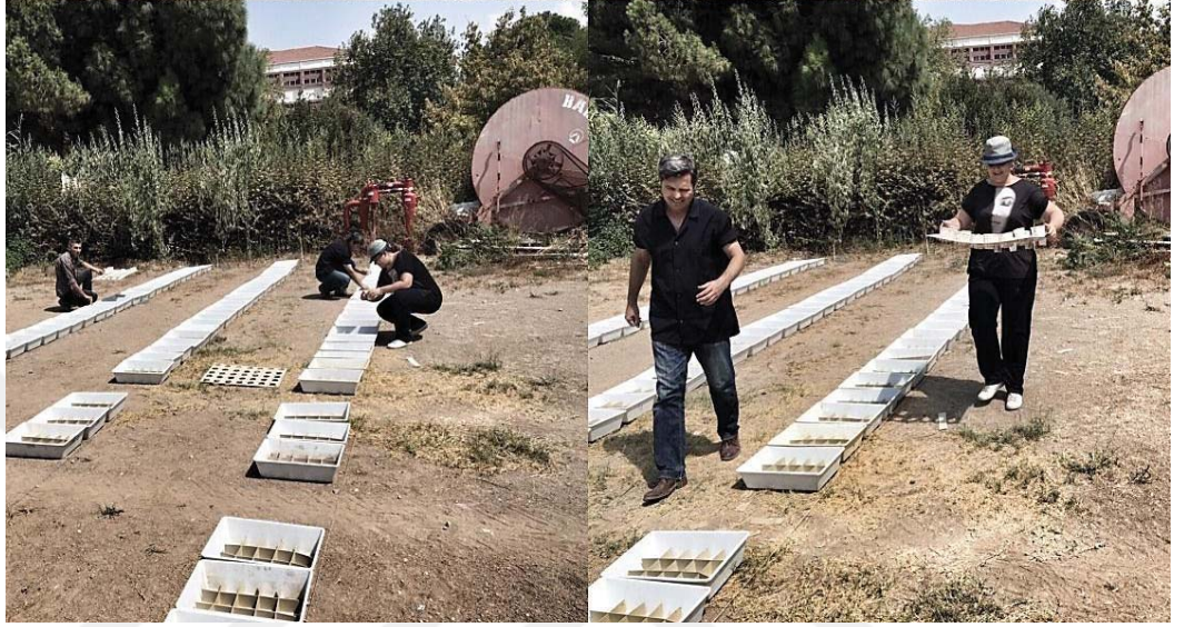
Şekil 3.8 Deneme sonrası toplama kaplarındaki gübre örneklerinin tartım için toplanması
