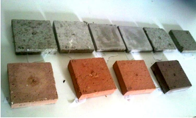
Şekil 4.4. Horasan harcı ve beton kalıpları
