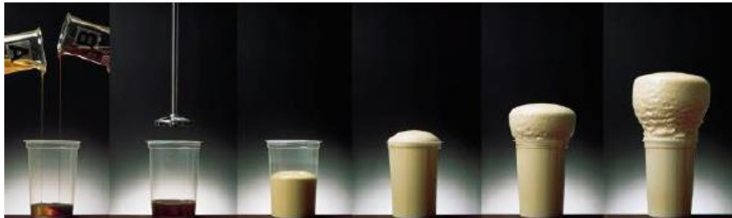
Şekil 6.8 PU kürlenme aşamaları (BASF)
