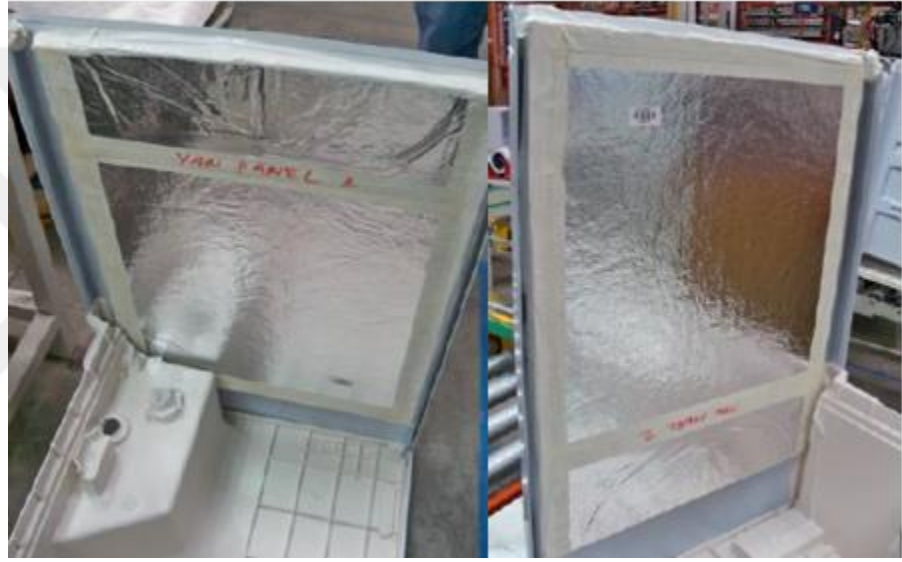
Şekil 6.12 VİP'li yan panel montaj görüntüsü (Müminoğlu, 2015)
