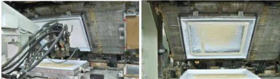
Şekil 6.11 Kapılar için kullanılan poliüretan basma sistemleri (Müminoğlu, 2015)
