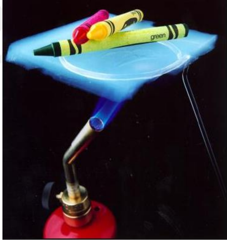
Şekil 2.18 Alev torcu üzerindeki bir aerojel (Nasa, 2017).
