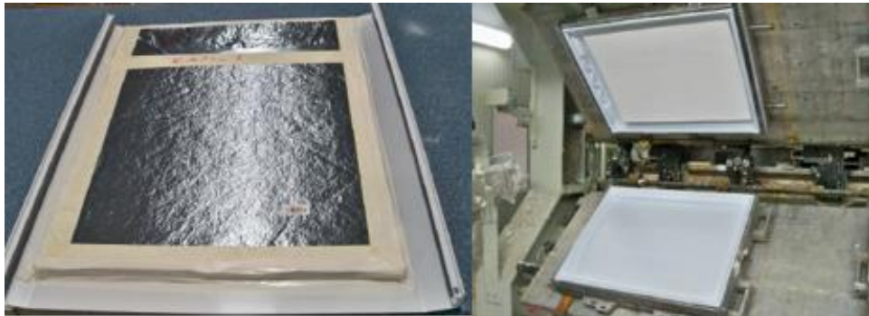
Şekil 6.13 VİP'li kapı montaj ve PU enjeksiyon görüntüsü (Müminoğlu, 2015)
