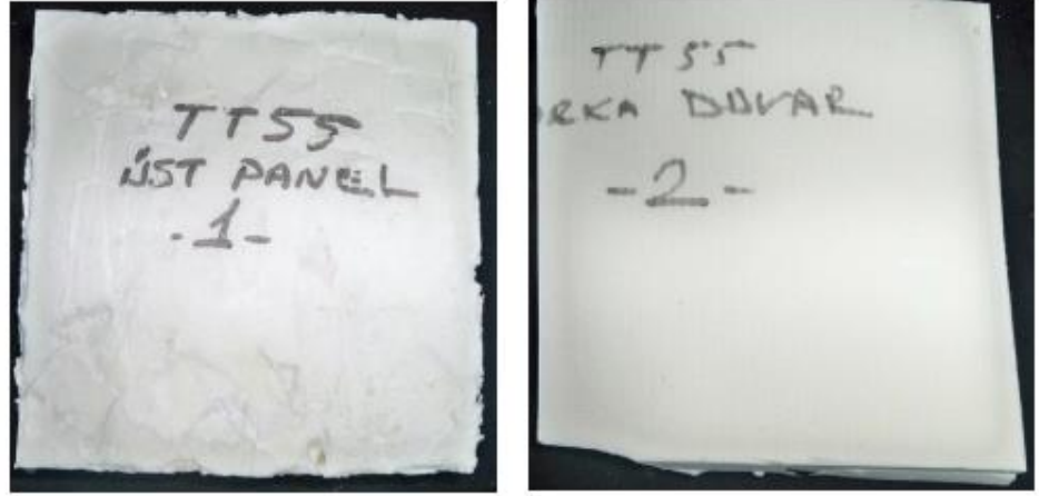
Şekil 6.5 Isı iletim katsayısı örneklenen PU numuneleri (Müminoğlu, 2015)
