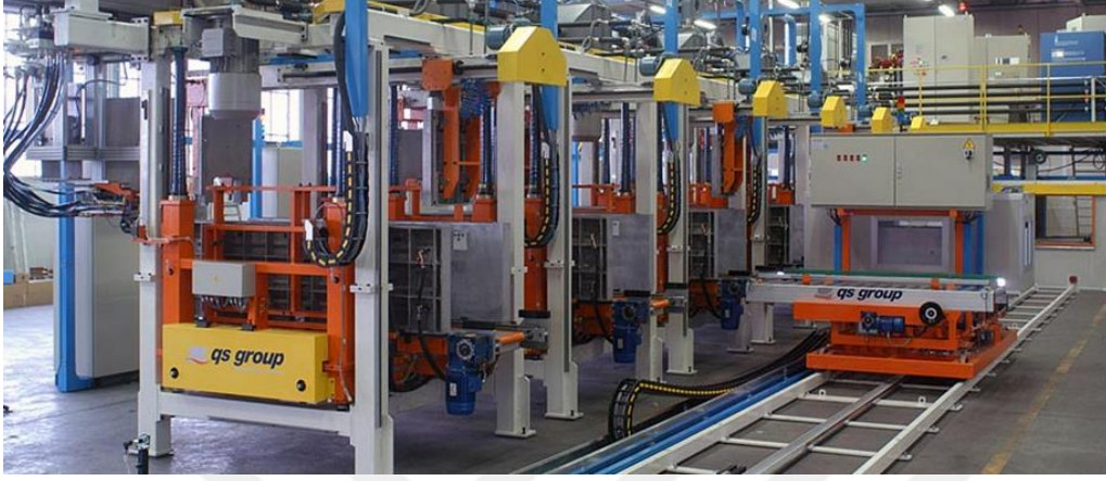
Şekil 6.9 PU basma fişstür sistemleri (QS Group, 2017)
