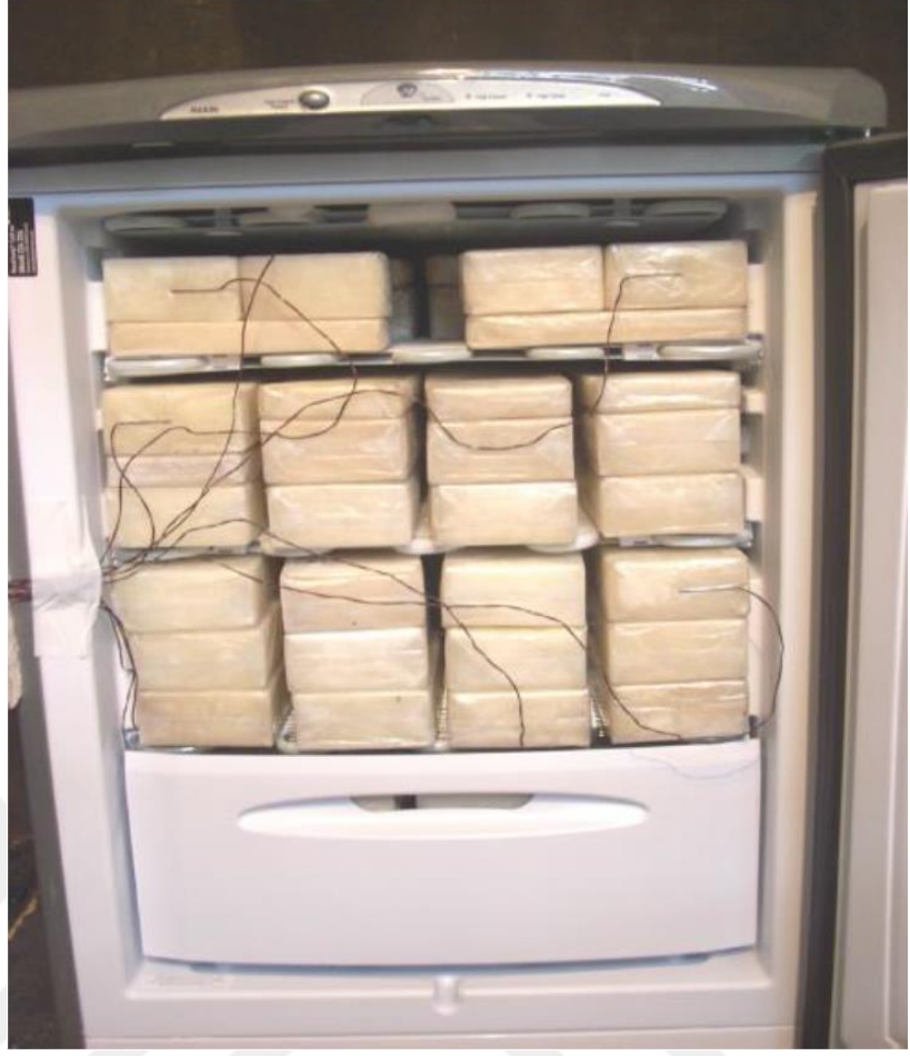
Şekil 7.3 Enerji ve performans testlerine hazırlanmış ürün (Müminoğlu, 2016)
