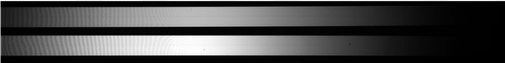
Şekil 2.3: Düzalın tayfı. CCD üzerindeki alanın eşit (homojen) olarak aydınlatılmasıyla alınan ve CCD çipinin ışığa olan tepkisinin belirlenmesini sağlayan bir kalibrasyon görüntüsüdür. Düz alan tayfının sol tarafında da görüldüğü üzere tayf, zebra görüntüsü veren " fringe " deseni oluşturmaktadır. Bu desenin görülmesi CCD yüzeyinde oluşan ışık girişim olayıdır.
