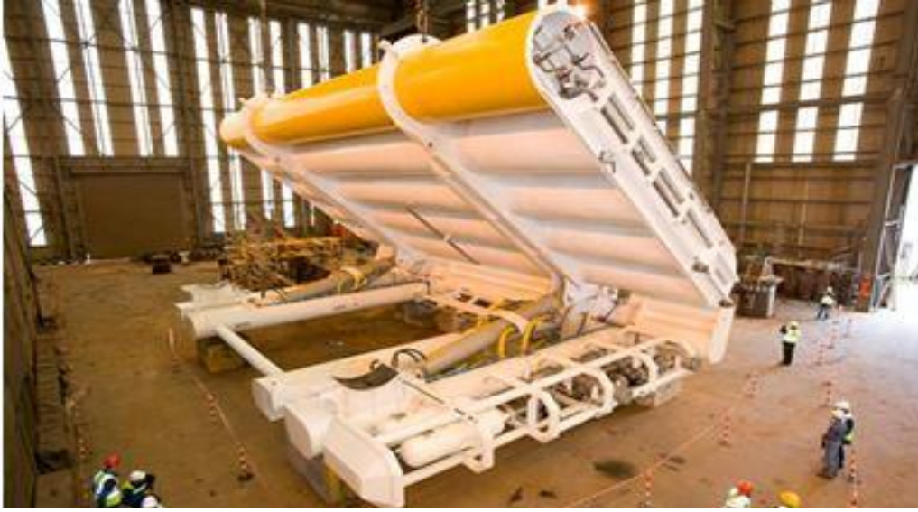
Şekil 2.31. Oyster tipi dalga enerji dönüştürücüsü [67].
