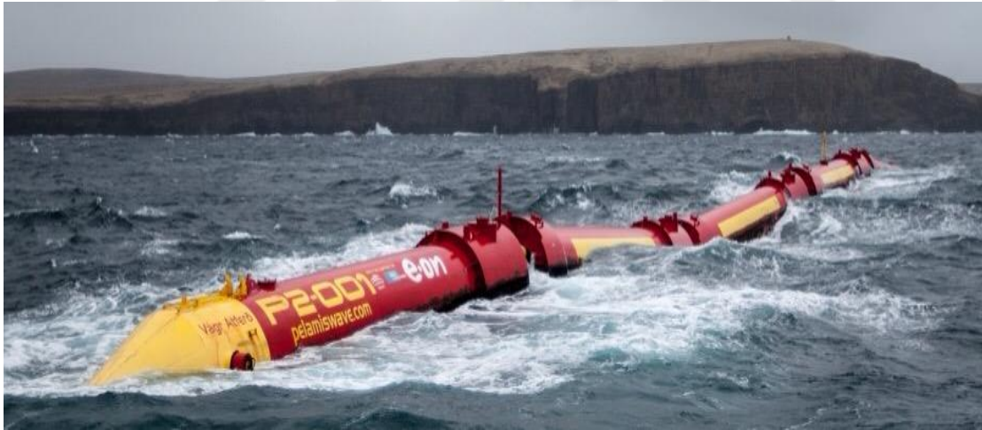
Şekil 2.27. Pelamis tipi dalga enerji dönüştürücüsü [56].
