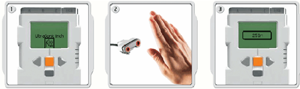
Şekil 2.18. NXT’de ultrasonik sensör işlevleri (1) Ultrasonik sensörü için inch ve cm seçenekleri (2) Ultrasonik sensörünün mesafeyi algılaması (3) Ultrasonik sensörü ölçüm işlemi.
