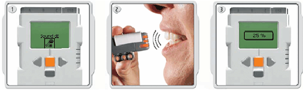
Şekil 2.12. NXT’de ses sensörü işlevleri (1) Ses sensörü için dB ve dBa seçenekleri (2) Ses sensörünün ses dalgalarını algılaması (3) Ses sensörü ölçüm işlemi.
