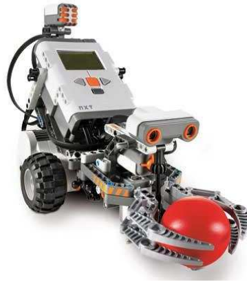
Şekil 2.26. İstenen renkte topu otonom olarak arayıp bulan robot.
