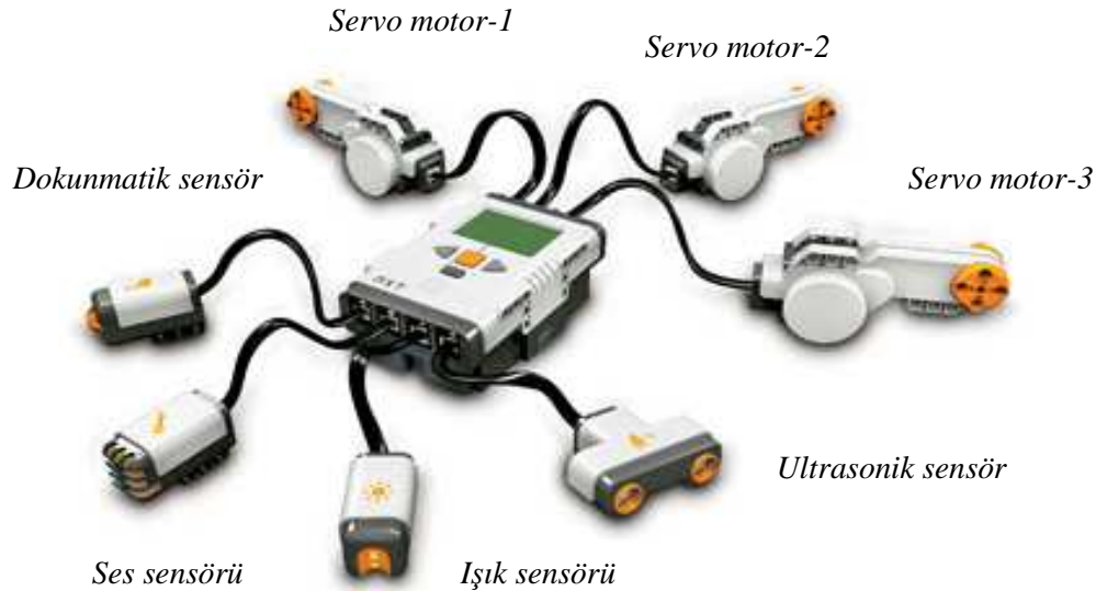
Şekil 2.6. NXT'ye bağlı 3 servo motor ve 4'lü sensör sistemi.
