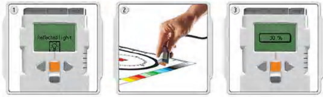
Şekil 2.13. NXT’de ışık sensörü işlevleri (1) Işık sensörü için reflected light ve ambient light seçenekleri (2) Işık sensörünün ışık seviyesini algılaması (3) Işık sensörü ölçüm işlemi.
