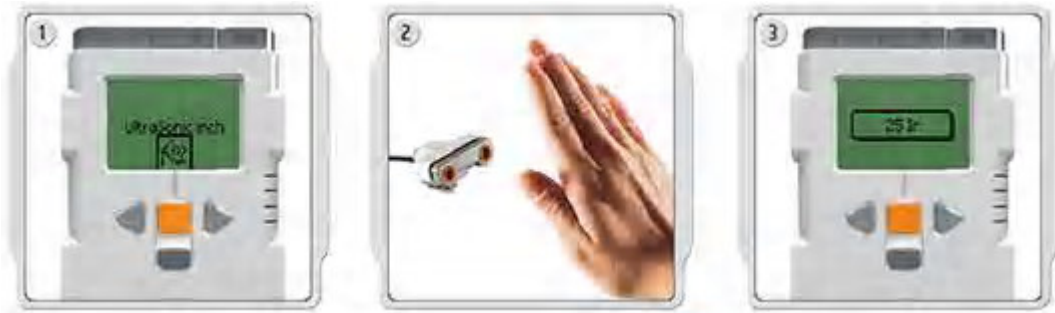
Şekil 2.16. NXT’de ultrasonik sensör işlevleri (1) Ultrasonik sensörü için inch ve cm seçenekleri (2) Ultrasonik sensörünün mesafeyi algılaması (3) Ultrasonik sensörü ölçüm işlemi.
