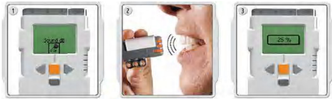
Şekil 2.10. NXT’de ses sensörü işlevleri (1) Ses sensörü için dB ve dBa seçenekleri (2) Ses sensörünün ses dalgalarını algılaması (3) Ses sensörü ölçüm işlemi.
