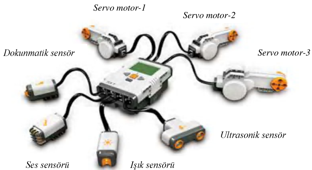
Şekil 2.4. NXT'ye bağlı 3 servo motor ve 4'lü sensör sistemi.
